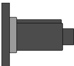
4. Placez le rouleau pré-monté sur l'axe supérieur de la machine et serrez les vis avec la clé Allen
