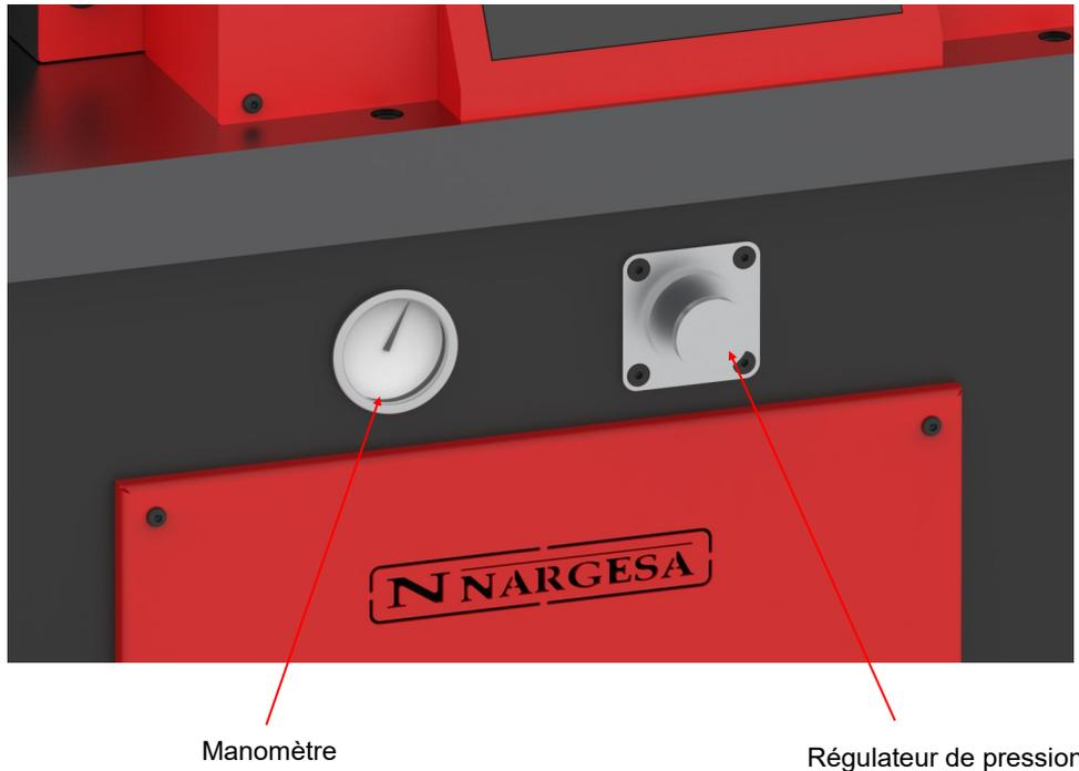
Image 12. Éléments du réglage de la force.
