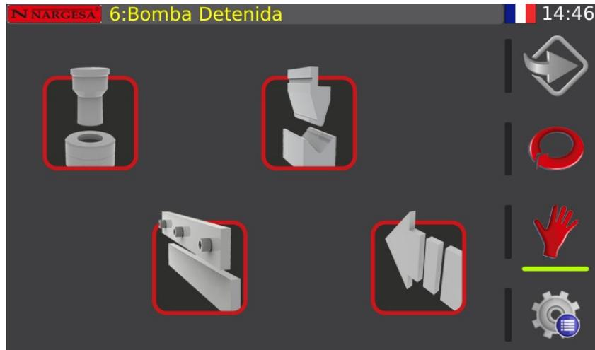
À ce stade, la machine se trouve en « StandBy » (repos) ; c'est-à-dire que la machine est activée, mais qu'elle est maintenue en mode repos, en attente d'effectuer une opération :
