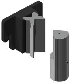
Matrice de pliage jusqu'à 161mm avec 4 ouvertures (16, 22, 35, 50mm) et un poinçon de 80°. Cette forme permet de plier des tôles de 1mm à 8 mm. Le poinçon de diamètre extérieur de 70 mm permet de réaliser des formes complètement fermées jusqu'à un minimum de 75mm d'aile intérieure.
