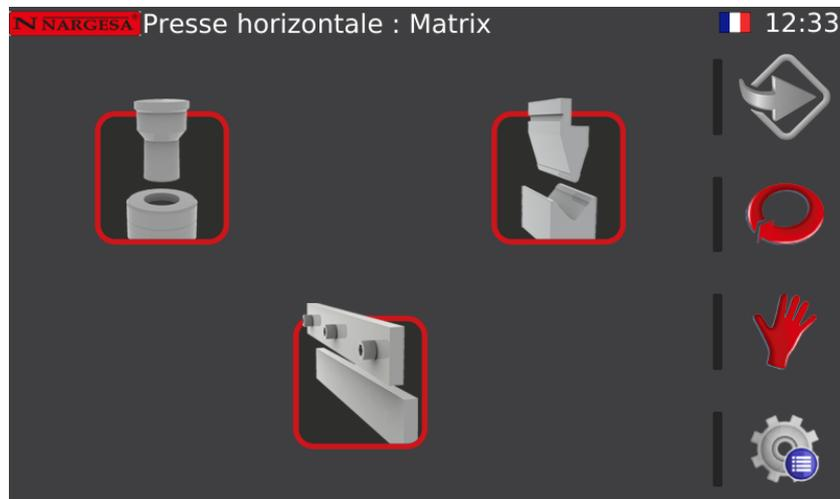
Grâce à cette interface, nous sélectionnons le type d'outil en question, ou en d'autres termes, si nous allons utiliser cet outil pour poinçonner, plier ou cisailer. Eh bien, les icônes et leurs fonctions sont présentées ci-dessous :
