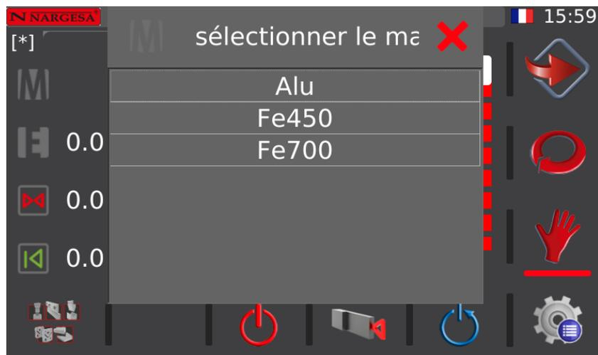
Appuyez sur la touche **E** pour insérer l'épaisseur du matériau en millimètres ou en pouces selon la configuration :
