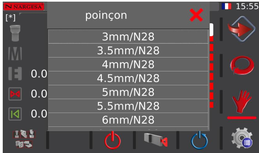
La CNC sélectionne automatiquement l'un ou l'autre en fonction de votre choix. Autrement dit, si vous sélectionnez un poinçon, la CNC sélectionne la matrice adaptée à ce poinçon.
