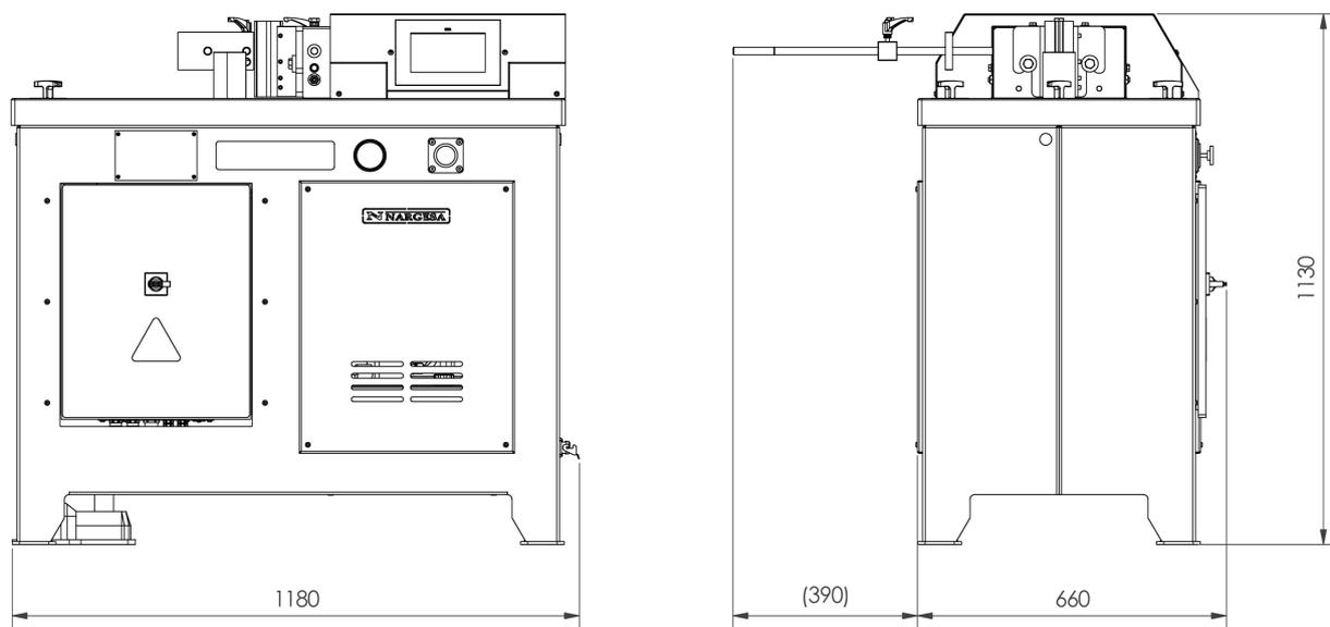
Image 1. Dimensions extérieures de la Presse plieuse horizontale.
