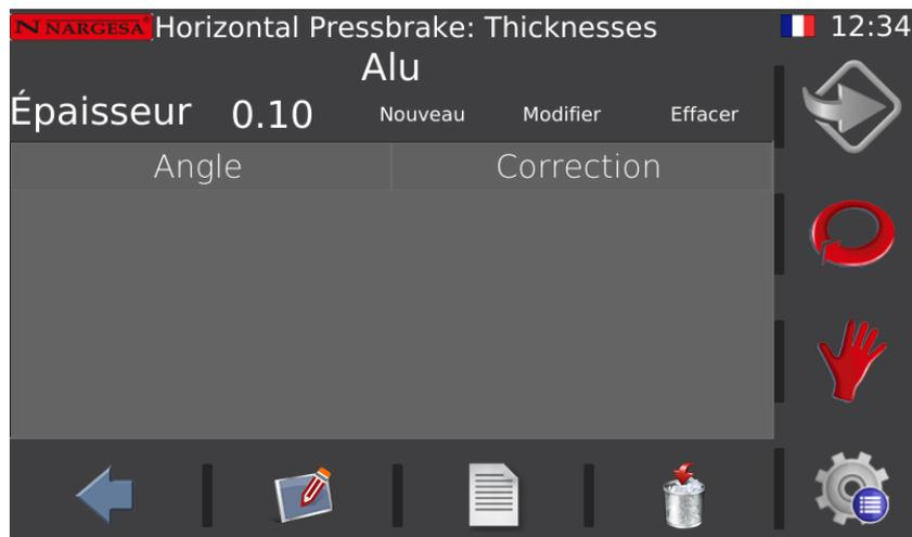
Une fois à l'intérieur de cette fenêtre, il est possible de créer, modifier ou supprimer des épaisseurs en appuyant sur le texte situé sur la ligne horizontale à la hauteur de l'épaisseur.
