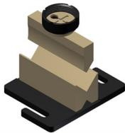
Matrice de pliage de tôle et barre plate jusqu'à 170mm. Poinçon de 88°. Matrice en V de 56mm et V de 26mm
