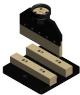
Matrice de pliage de tôle et barre plate jusqu'à 350mm. Poinçon de 88°. Matrice en V ajustable de 120mm, 80mm, 40mm et 16mm.
