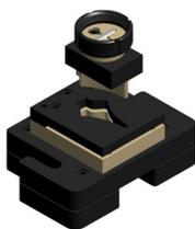
Matrice pour découper la tôle en forme de flèche pour les clôtures.
