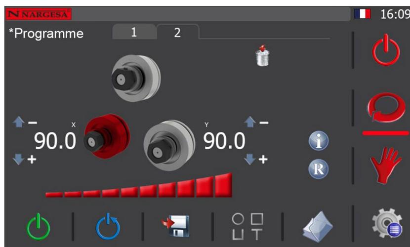
La deuxième étape d'un programme est « l'étape de chargement » qui consiste à positionner les galets de la cintreuse de manière à permettre l'entrée du matériau à usiner dans la machine.
