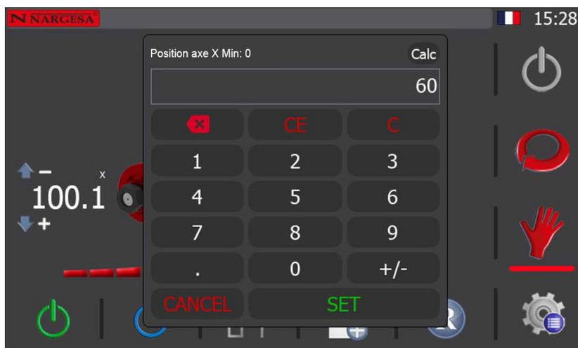
Lorsque la fenêtre apparaît, saisissez la cote de destination souhaitée à l'aide du clavier. Dans l'exemple ci-dessus, « 60 ». Après avoir saisi la cote, pressez le bouton « SET » pour confirmer et fermer la fenêtre.
