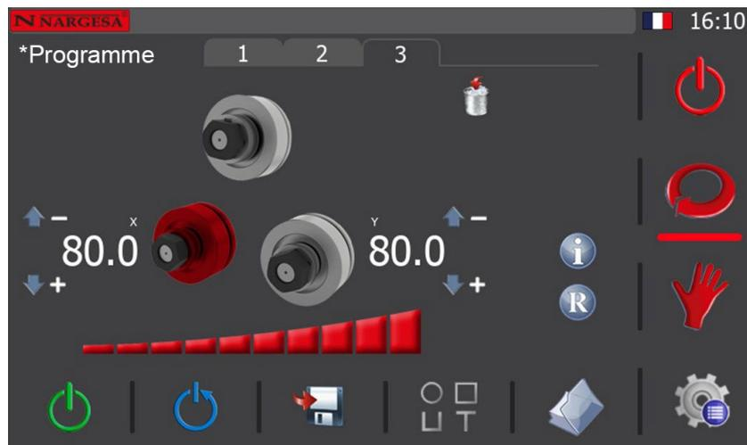
Une fois cela fait, l'application crée une troisième étape de programme. Il s'agit de « l'étape de pince » qui consiste à fixer fermement le matériau, chargé dans la machine et prêt à être usiné, entre le galet supérieur et les deux galets inférieurs.
