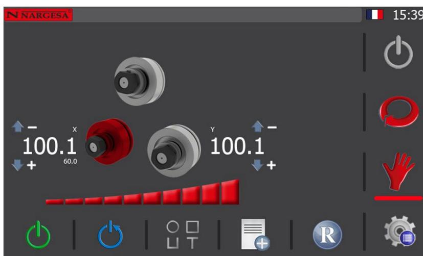
À ce stade, la machine est en mode de positionnement du galet de l'axe X en attente que vous exécutiez le déplacement à l'aide du bouton orange sur l'avant du pupitre de commande. Pour ce faire, maintenez pressé le bouton orange pour déplacer le galet de l'axe X de sa cote actuelle (100,1) sur la cote de destination (60) ; une fois que le galet atteint la cote de destination, le processus de positionnement est terminé et la cote de destination cesse d'être affichée à l'écran.
