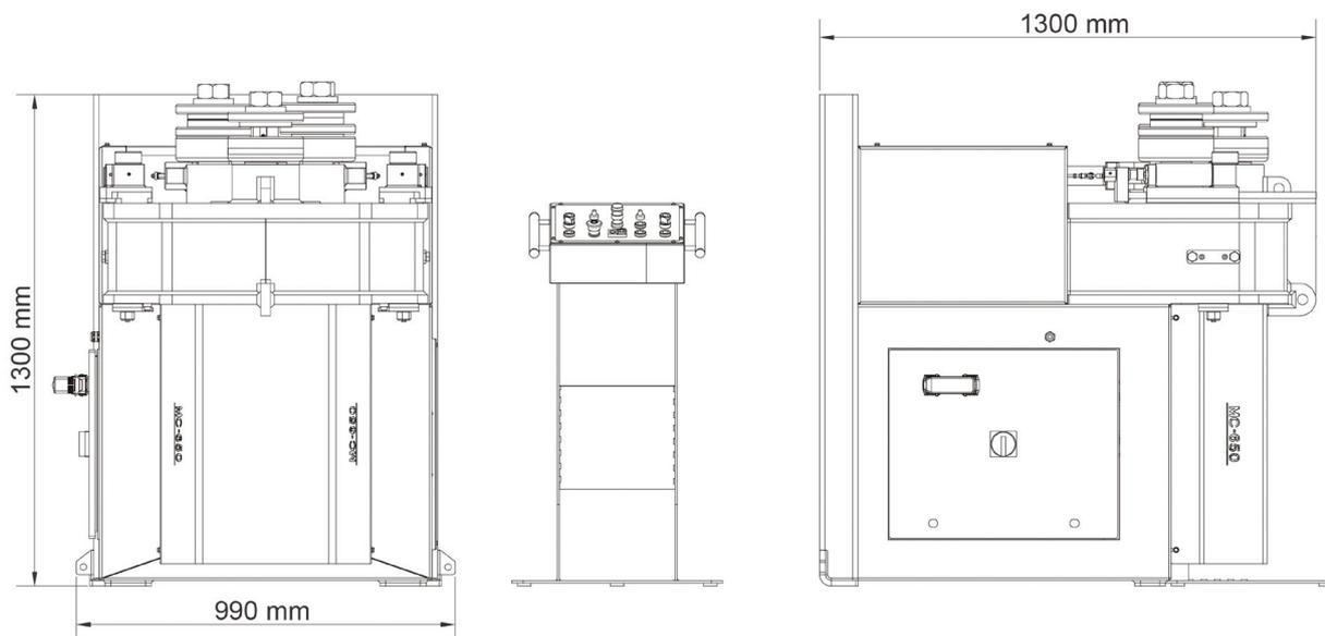
*Illustration 10. Dimensions de la machine avec le bâti en position horizontal*
