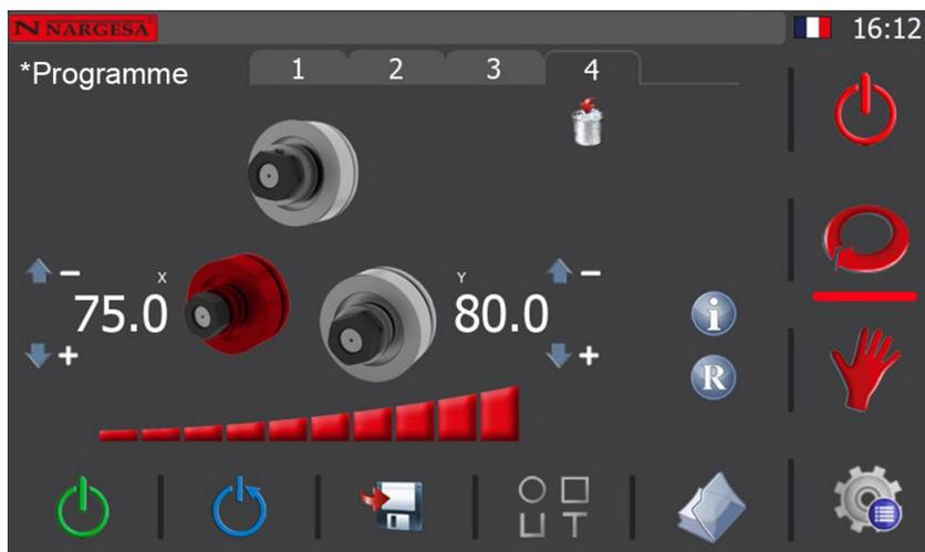
Une fois le matériau fixé dans la machine, vous pouvez le positionner pour exécuter le cintrage en faisant tourner les galets vers la droite ou vers la gauche, comme expliqué précédemment à la section du mode de fonctionnement manuel.
