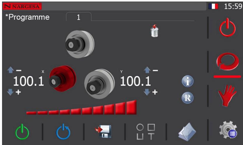
Pour établir la cintreuse en mode de fonctionnement automatique, pressez l'icône
