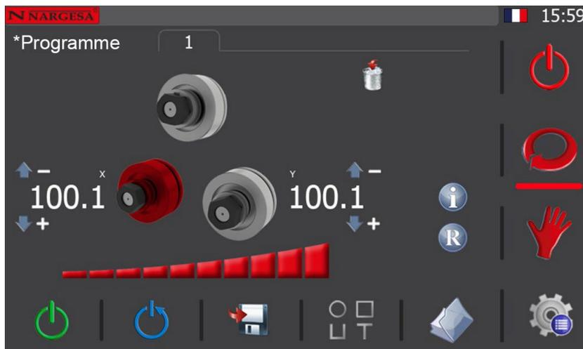
La première étape d'un programme est « l'étape de déchargement » et, comme son nom l'indique, cette l'étape consiste à positionner les galets de manière à pouvoir retirer la pièce sans heurter les galets. Pour créer cette étape, il suffit de placer les galets des axes X et Y sur une position qui permet de retirer facilement la pièce finie, une fois le processus terminé.
