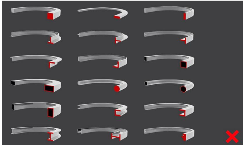
Ce faisant, une fenêtre contextuelle apparaît montrant les différents profils avec lesquels la machine peut travailler.
