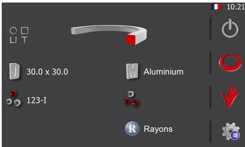
Dans l'exemple d'écran ci-dessus, le profilé sélectionné (affiché en haut) est un profilé carré plein. Dans ce cas, les dimensions qui ont été établies pour le profilé sont : 30 x 30. Pour établir les dimensions du profilé, pressez l'icône
