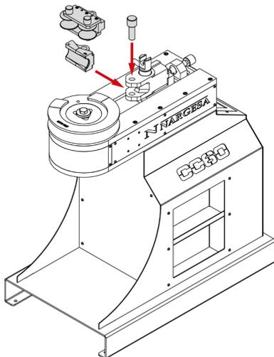
4. Insérez le matériau dans le guide de la forme, puis fixez-le à la bride d'entraînement.
