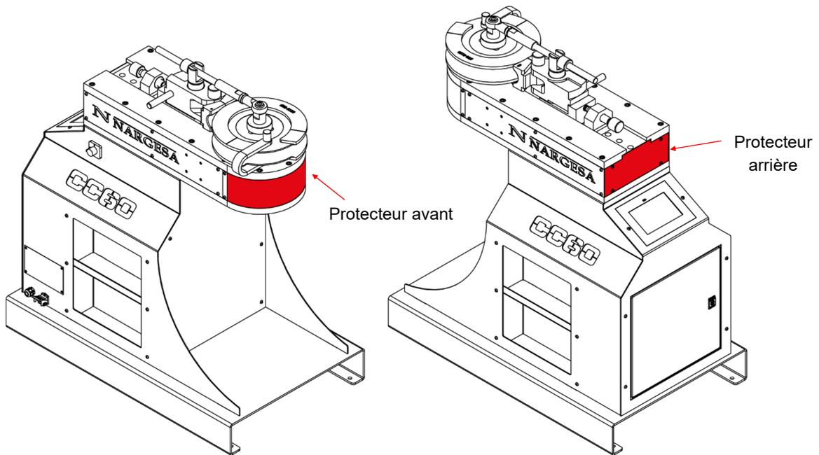
Figure 3. Protecteurs des mécanismes
