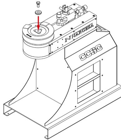
3. Installez la contre-forme ou les galets porteurs sur le positionneur, puis fixez-la/les.
