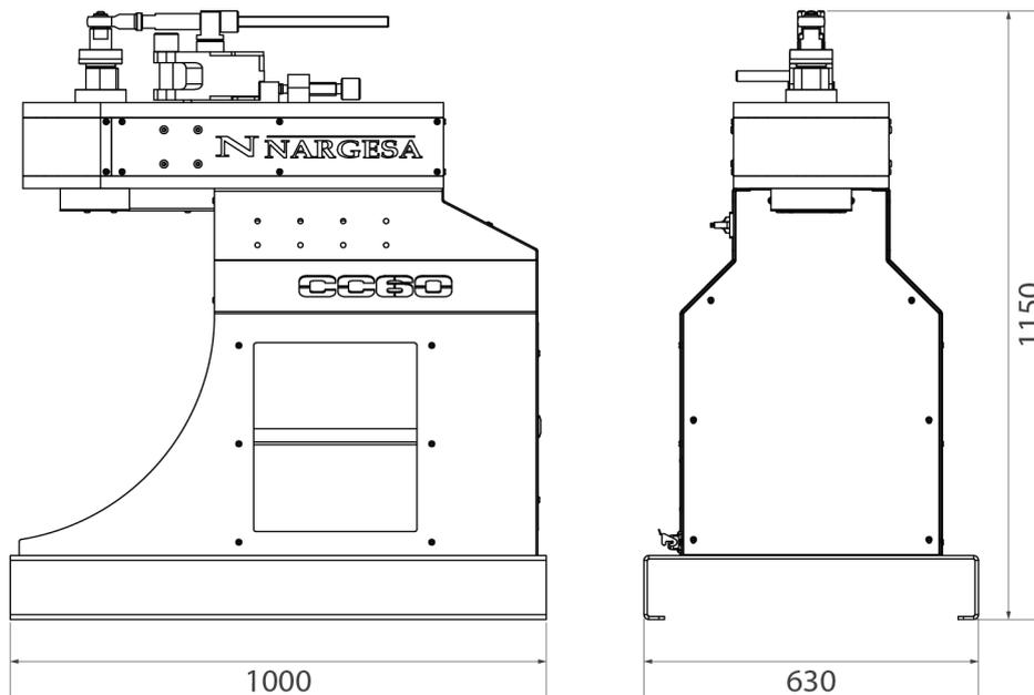
Figure 1. Dimensions extérieures de la cintreuse CC60
