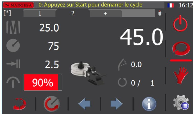
Si vous devez réaliser deux cintrages avec un degré d'angle identique, il n'est alors pas nécessaire d'ajouter une nouvelle opération au programme. Pour réaliser des répétitions, utilisez l'outil conçu à cet effet en pressant l'icône ↺ et saisissez le nombre de fois que le cintrage doit être répété. Dans ce cas, en ce qui concerne le cintrage numéro 2 du programme, la machine exécutera 3 cintrages de 45 degrés.
