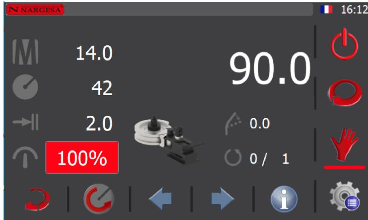
À ce stade la machine se trouve en «StandBy» (repos); c'est-à-dire que la machine est activée, mais qu'elle est maintenue en mode repos, en attente d'effectuer une opération.
