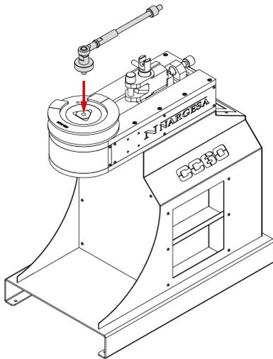
8. Installez la barre de renfort dans la gorge du positionneur, puis serrez l'écrou à la main jusqu'à ce que cet élément soit serré et fixe.
