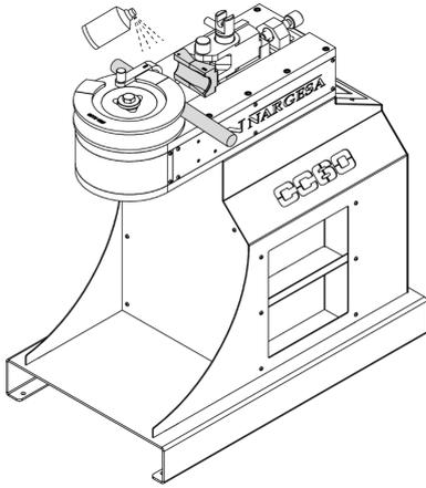
6. Faites glisser le positionneur de la contre-forme jusqu'à ce qu'il soit ajusté au matériau.
