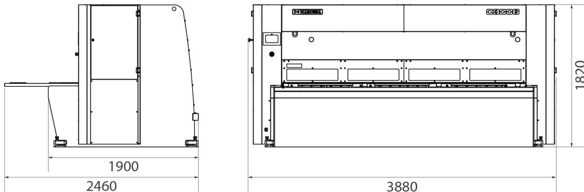
*Figure 1. Dimensions de la cisaille*
