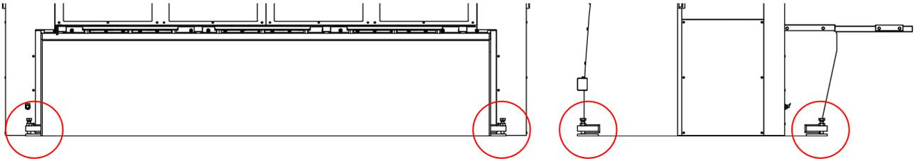
Figure 5. Vis pour niveler la machine
