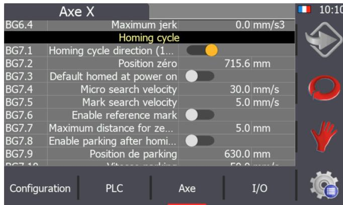
Pour vérifier que la nouvelle cote de réglage de zéro est correcte, il est possible de refaire un contrôle de la butée comme cela est indiqué auparavant.
