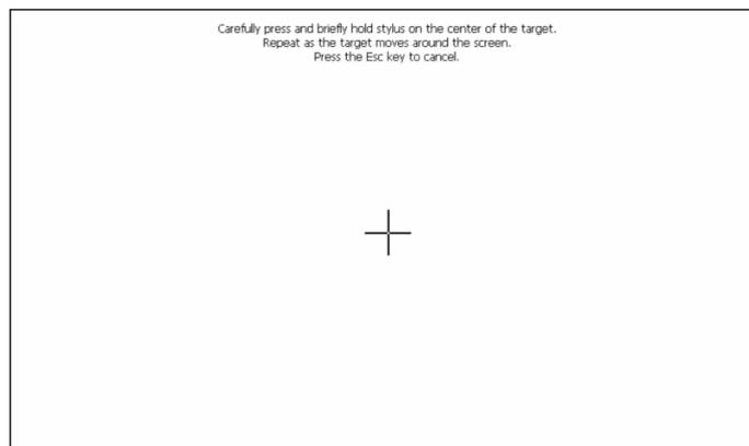
Au centre de la fenêtre apparaît une croix sur laquelle il faut appuyer jusqu'à ce qu'elle change de position. Ce processus est répété à plusieurs reprises et sur plusieurs points de l'écran jusqu'à ce que le calibrage tactile soit terminé.
