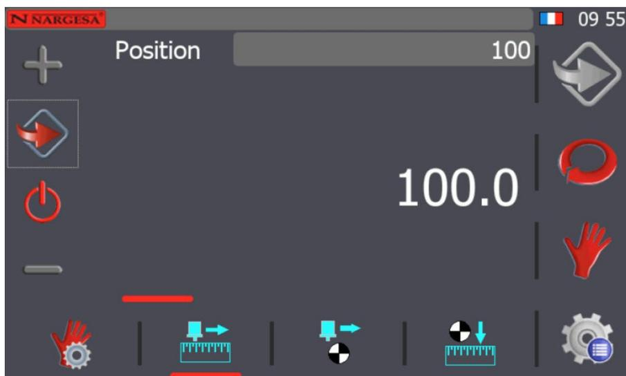
Maintenant, à l'aide d'un pied à coulisse ou d'une mire, nous contrôlons que la distance existante entre la butée et la ligne de coupe marquée par le faisceau laser lumineux corresponde à 100 mm (ou la valeur de cote que nous avons indiquée auparavant).
