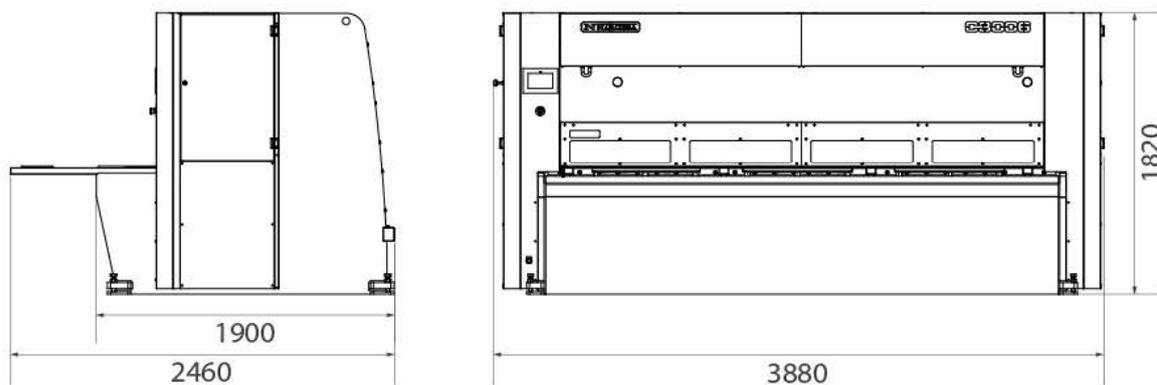
Figure 1. Dimensions de la cisaille
