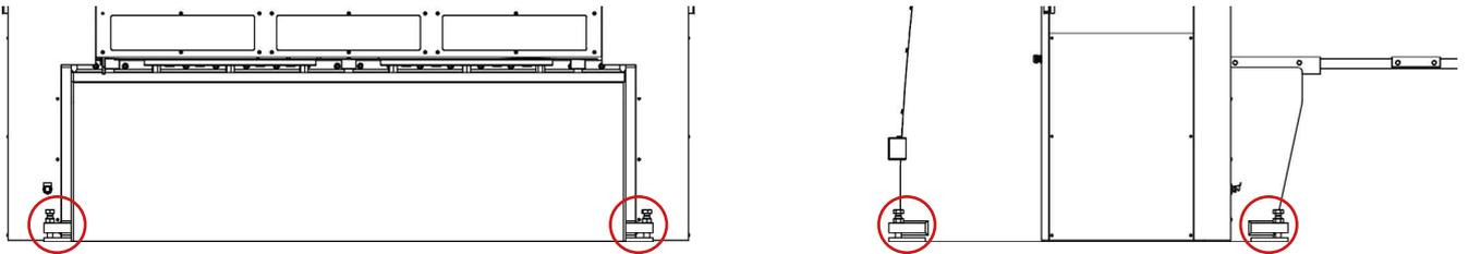
Figure 10. Vis pour niveler la machine
