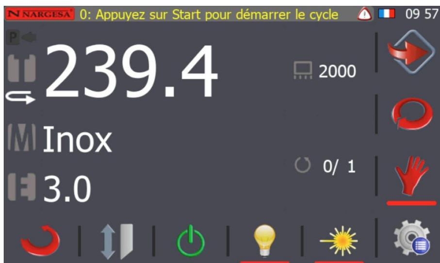
Quand cette icône apparaît sur l'écran, il est impossible de remettre la machine en marche. Par mesure de sécurité, ce triangle d'avertissement nous indique qu'il faut réarmer la cisaille. Pour ce faire, il faut appuyer sur le bouton bleu de réarmement et, de manière automatique, l'icône d'avertissement disparaîtra de la barre de notifications.
