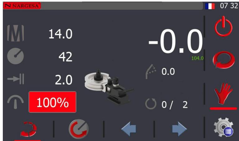
En fonction des paramètres établis, la machine fonctionnera à la vitesse de travail minimale.
