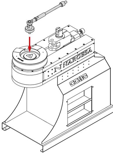
8. Installez la barre de renfort dans la gorge du positionneur, puis serrez l'écrou à la main jusqu'à ce que cet élément soit serré et fixe.
