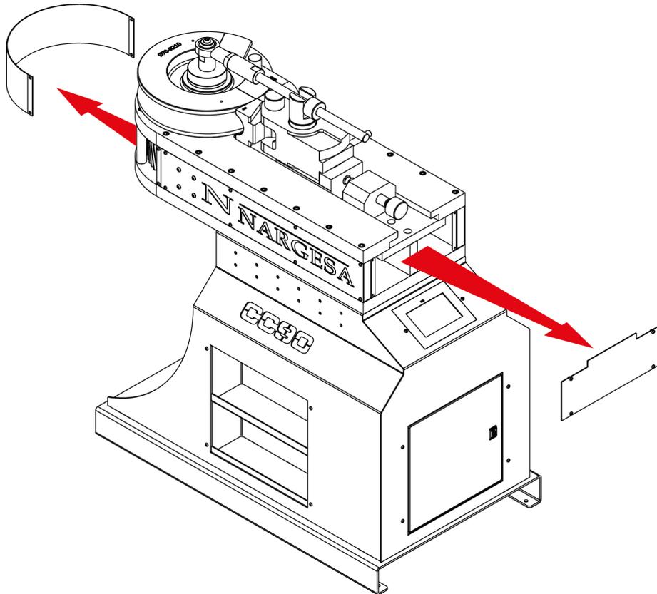
**ATTENTION** : avant de procéder au graissage de la machine, veuillez mettre la machine à l'arrêt et presser le bouton d'«arrêt d'urgence».
