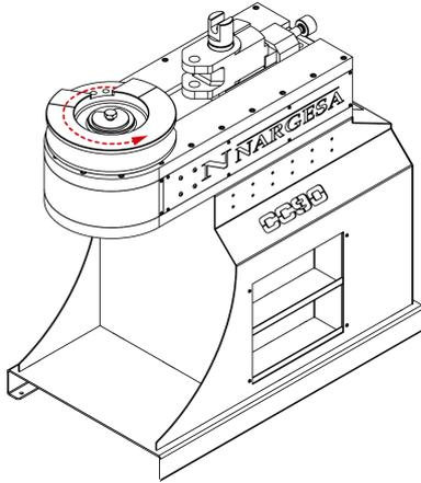
6. Nous faisons pivoter le positionneur 180° et le réintroduisons dans le chariot.
