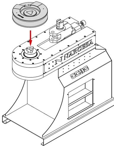
2. Fixez la forme au moyen de la rondelle et du boulon.
