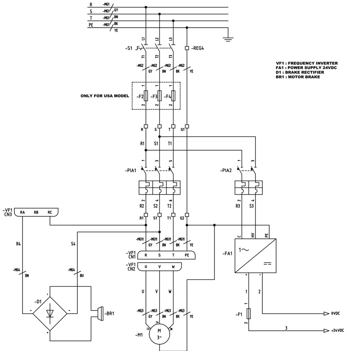
Schéma électrique · MACHINE MONOPHASÉE
