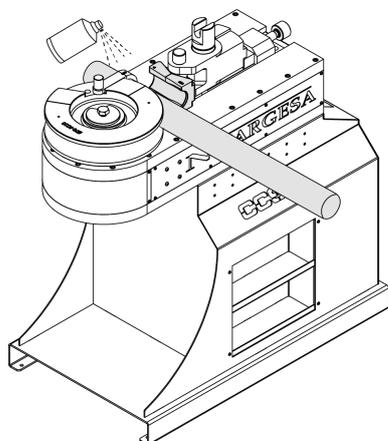
6. Faites glisser le positionneur de la contre-forme jusqu'à celui-ci soit ajusté au matériau.
