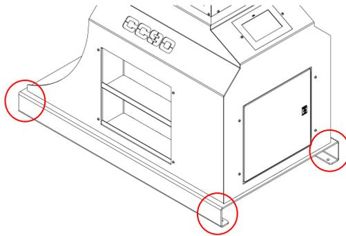
Figure 5. Points d'ancrage de la machine
