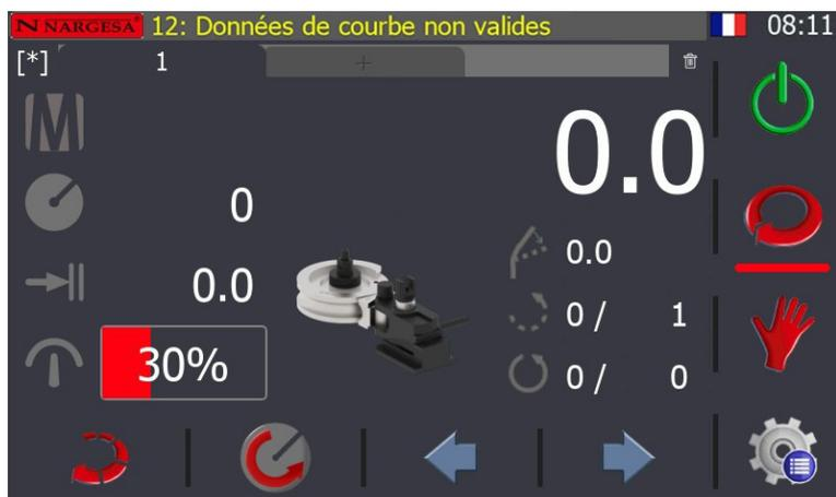
Remplissez les paramètres en suivant la même procédure qu'en mode manuel: saisissez la section du tube, le rayon de la forme, l'épaisseur du tube, le nombre de pièces requises et l'angle de cintrage.
