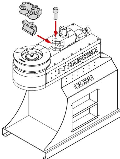
4. Insérez le matériau dans le guide de la forme, puis fixez-le à la bride d'entraînement.
