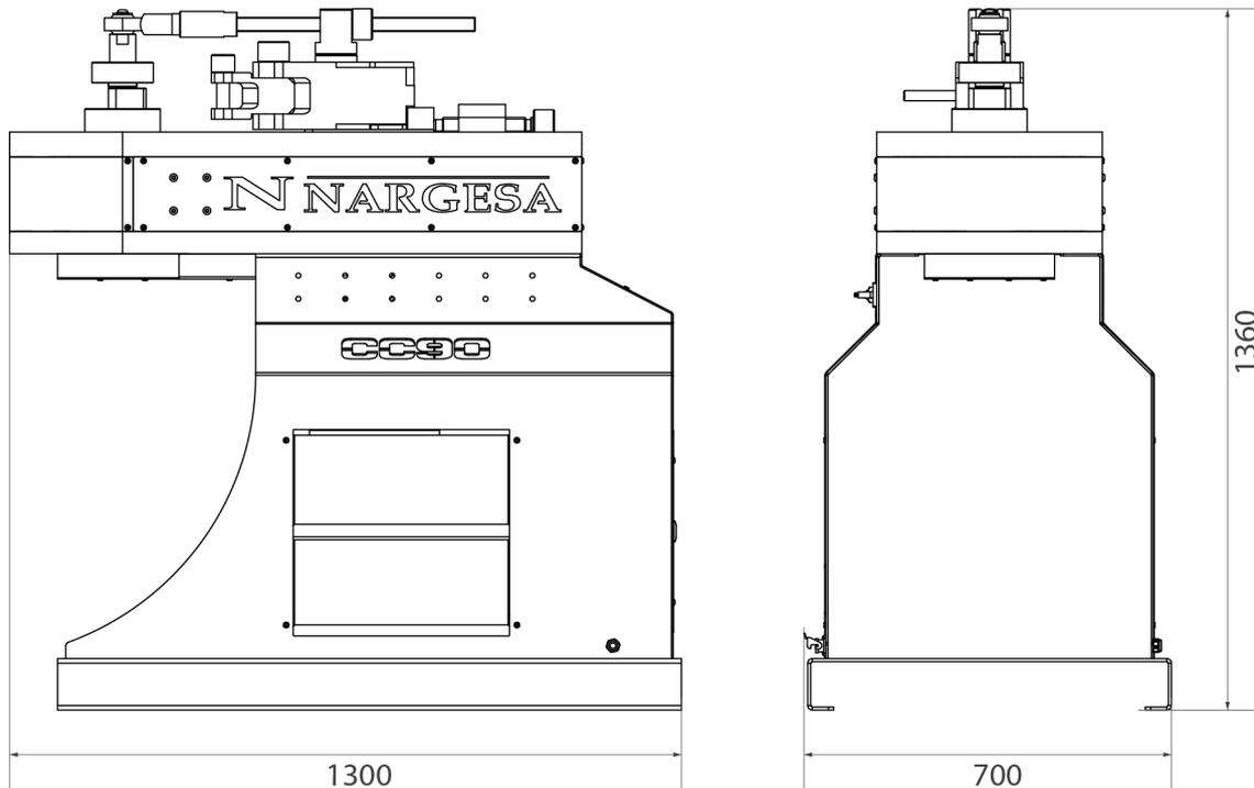
Figure 1. Dimensions extérieures de la cintreuse CC90
