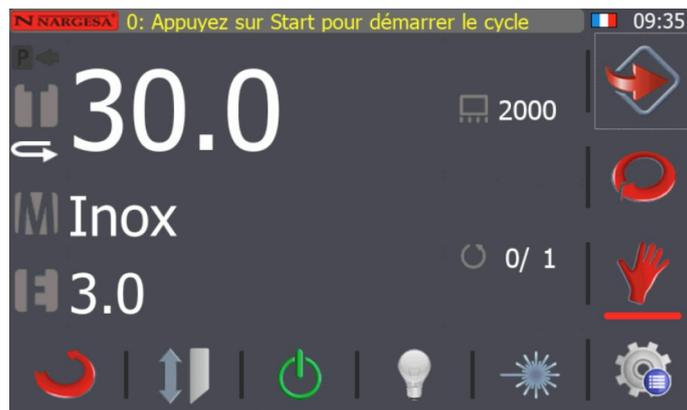
À ce moment, le contrôle permet de réaliser des coupes manuelles; il suffit simplement d'introduire les données correspondantes à la coupe. Pour introduire les mesures de coupe, il faut appuyer sur la mesure de coupe et cet écran apparaîtra.
