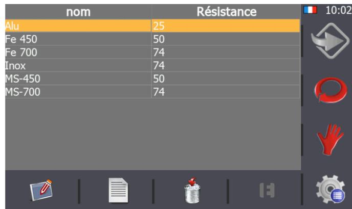
Par défaut, la cisaille en sortie d'usine dispose d'un tableau standard de matériaux. Il est possible d'ajouter, de modifier et d'éliminer des matériaux appartenant à ce tableau. Pour ce faire, il faut utiliser les icônes qui se trouvent dans la partie basse de l'écran.
