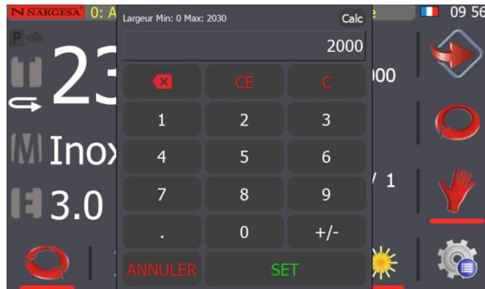
Il est maintenant possible d'introduire une nouvelle valeur de largeur pour la plaque latérale, entre un minimum de 0 et la cote maximale latérale spécifiée comme paramètre de fabrication.
