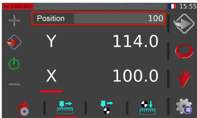
11. Mesurez la distance entre l'extrémité de la matrice et la butée.
