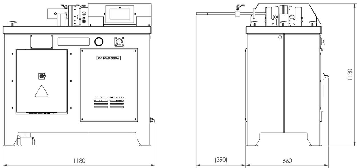
Figura 1. Dimensiones exteriores de la Prensa plegadora horizontal PP200CNC
