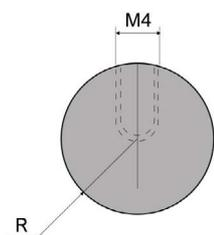
Elementos de radio para plegar. Fabricadas en C45, un acero de grado medio, de alta calidad, con propiedades mecánicas constantes y con buena resistencia cromada exteriormente.
