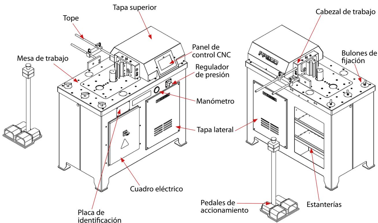
Figura 2. Identificación de los componentes
