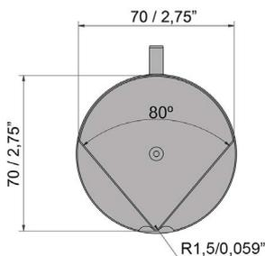
Punzón de plegar de 80°. El Punzón de diámetro exterior de 70 mm permite realizar figuras completamente cerradas de hasta un mínimo de 75mm de ala interior.
