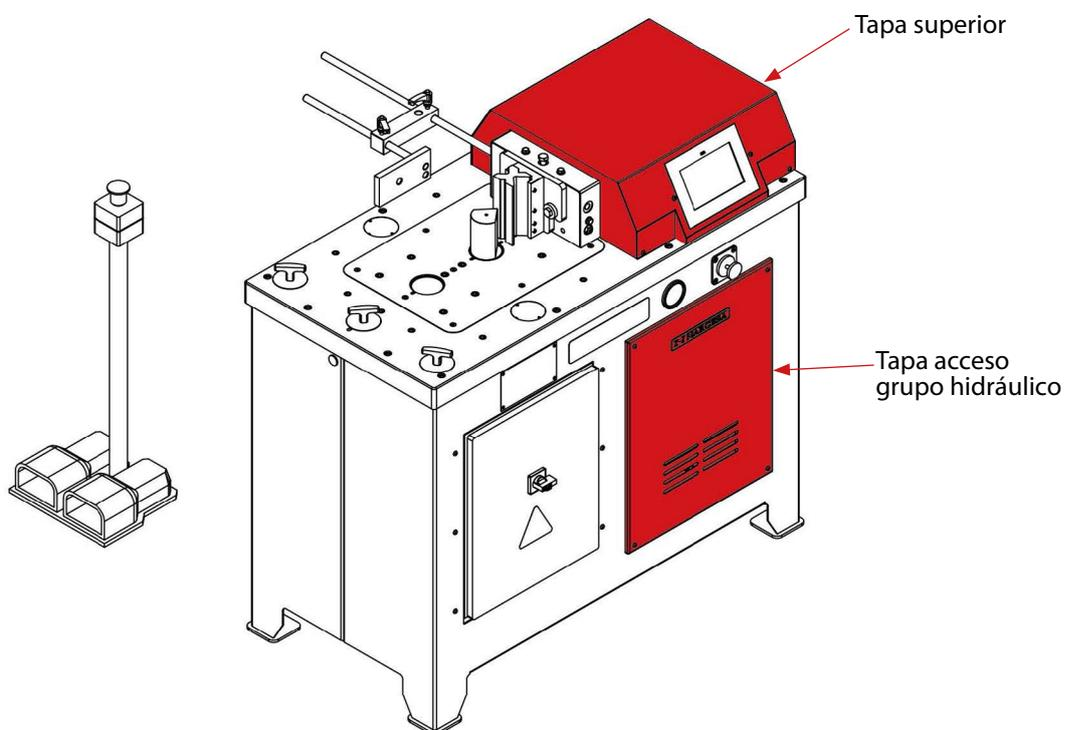
Figura 4. Localización de las protecciones de seguridad
