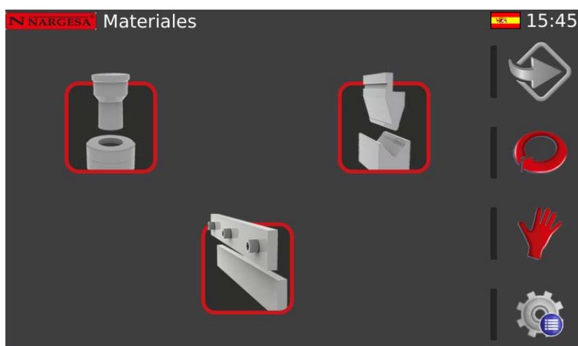
Mediante esta interfaz seleccionamos que tipo de herramienta es, o en otras palabras, si esta herramienta la vamos a usar para punzonar, plegar o cizallar. Pues bien, los iconos y sus funciones se muestran a continuación:
