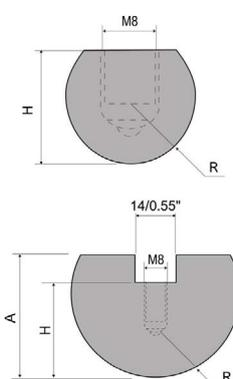
Elementos de radio para plegar. Fabricadas en C45, un acero de grado medio, de alta calidad, con propiedades mecánicas constantes y con buena resistencia cromada exteriormente.
