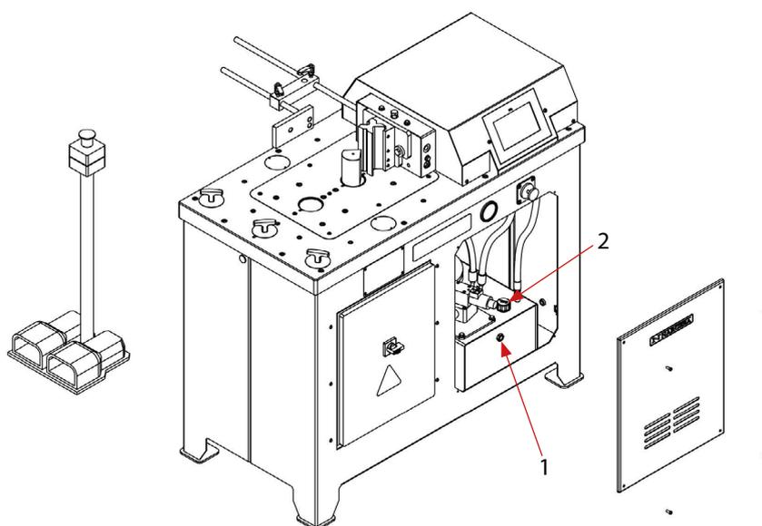
Figura 6. Localización de los elementos para el mantenimiento hidráulico
