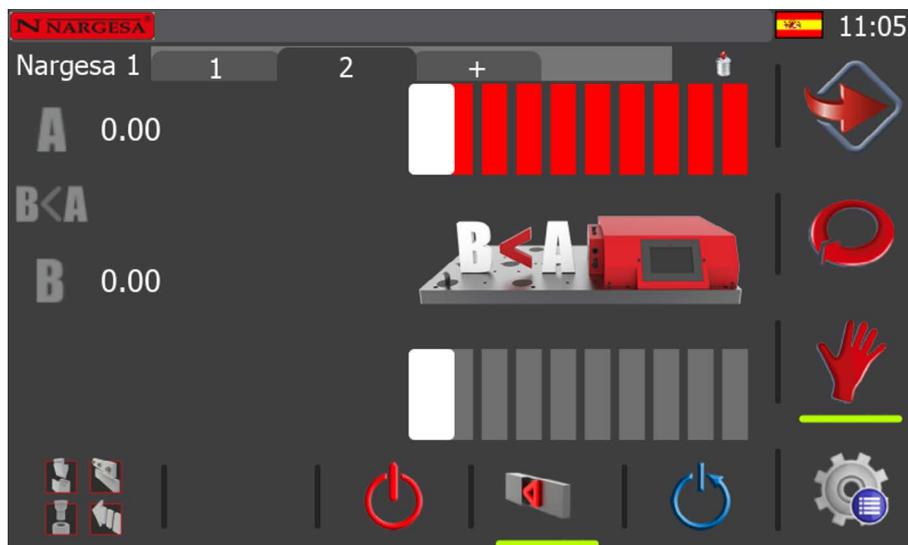
Para realizar cualquier función en Modo manual deberemos introducir los siguientes parámetros en el CNC. Pulsaremos la tecla **A** para introducir la cota de inicio del pistón:
