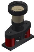
Extractor que en el momento del punzonado actúa como enderezador para evitar que las pletinas se doblen en el momento de la perforación.
