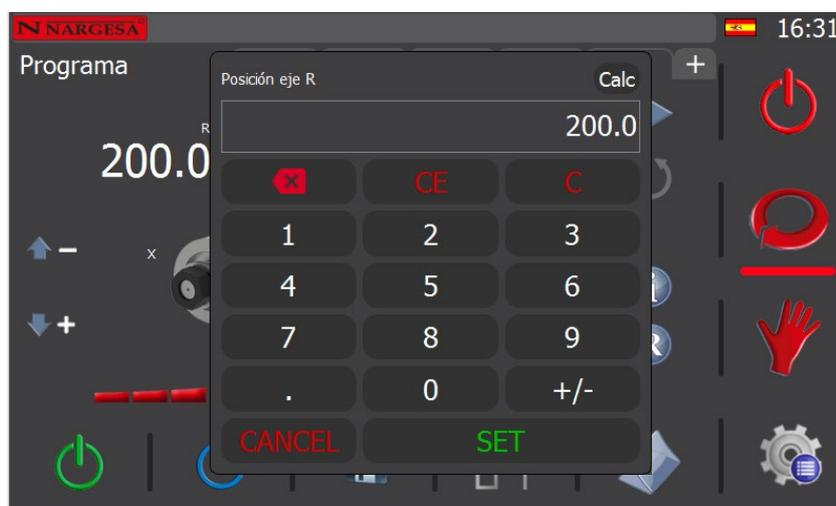
Utilice el teclado numérico para realizar el ajuste de la cota del eje seleccionado. Para confirmar presione la tecla "SET".
