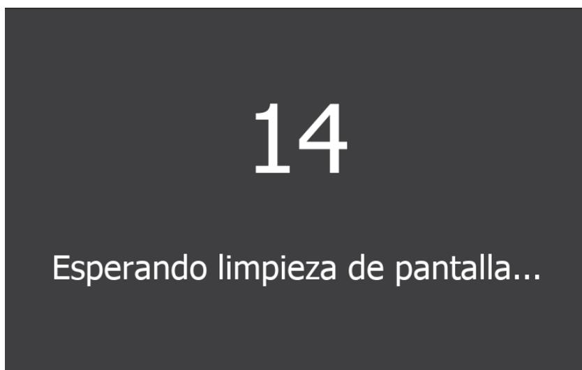
Ahora aparece una cuenta atrás de 15 segundos, durante los cuales, cualquier acción sobre la ventana no tiene ningún efecto. Este simple proceso nos da un tiempo limitado para realizar la limpieza del panel táctil sin miedo a realizar acciones no deseadas. Transcurridos los 15 segundos la aplicación regresa de forma automática al menú general. Si aún no ha tenido el tiempo suficiente para realizar la limpieza completa del panel puede repetir la misma operación tantas veces como lo desee.
