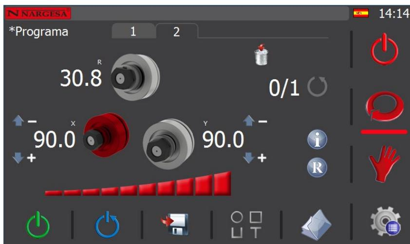
El segundo paso de un programa se denomina “paso de carga” y es aquel en que la posición de los rodillos de la curvadora permite entrar el material con el que trabajar en la máquina.
