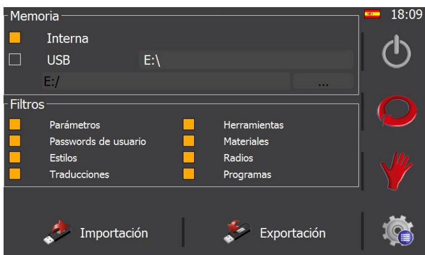
Mediante esta pantalla podemos exportar los datos creados en el PC e importarlos en la máquina física. O de forma inversa, es decir, si un operario ha creado nuevos materiales, herramientas, radios o programas sobre la máquina, estos datos se pueden exportar de la máquina e importarlos en el PC para la finalidad deseada.
