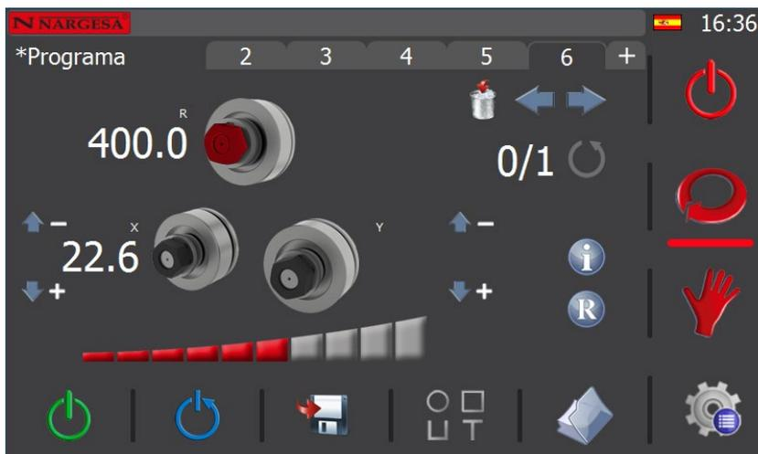
Si seleccionamos el eje R interpolado, vemos también como este y la tuerca de sujeción de los rodillos aparecen resaltados en color rojo. En este caso, a diferencia de lo visto en el eje interpolado X, sí hemos decidido modificar la velocidad máxima para este eje, dejándola en un 60%.
