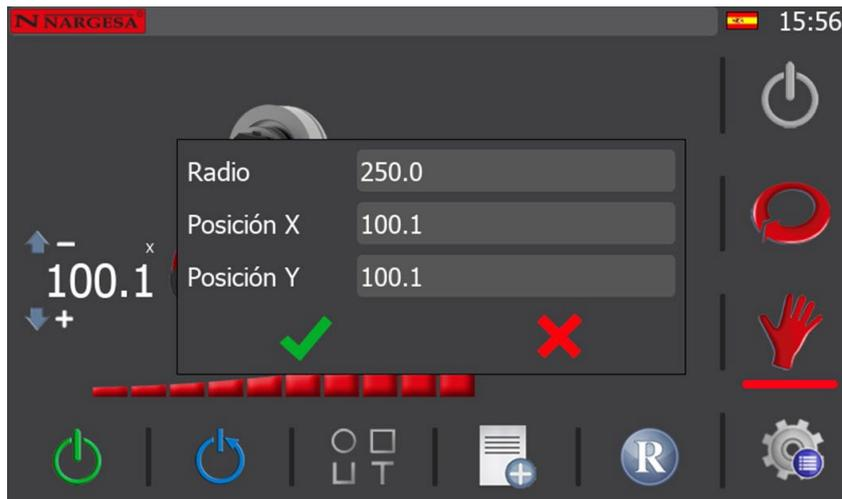
De forma automática se captura la posición de los rodillos X e Y, con lo que lo único que usted debe hacer ahora es medir el radio obtenido en la primera curva que acaba de crear, e introducir su valor en el campo "Radio" de la imagen anterior.
