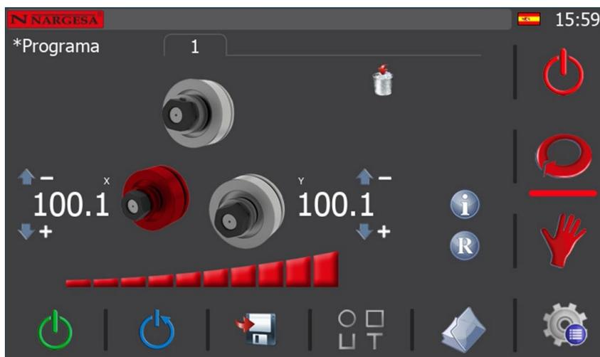
El primer paso de un programa se denomina “paso de descarga” y, como su nombre indica, es aquel en el que la posición de los rodillos permite extraer la pieza creada sin que colisione con los rodillos. Por lo tanto, para crearlo, no tiene más que posicionar los rodillos de los ejes X e Y en una cota tal que le facilite, a posteriori, retirar la pieza terminada una vez acabe de crearla.
