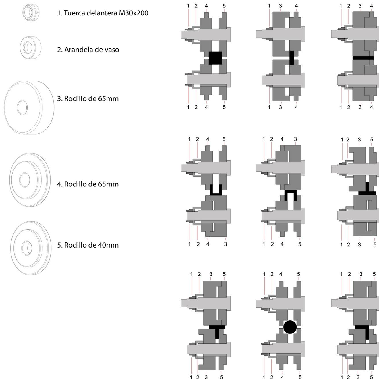
Figura 11. Nomenclatura de los rodillos y ensamblaje
