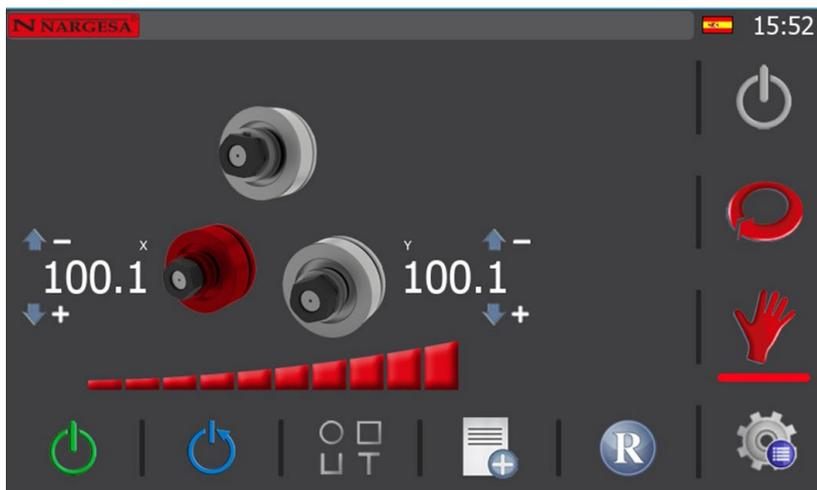
Ahora es cuando puede comenzar a crear la barra de muestra. Para hacerlo, posicione cada uno de los rodillos en una cota tal que pueda cargar en la máquina, sin problemas, el perfil con el que va a trabajar.
