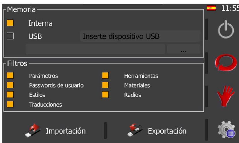
Mediante esta pantalla podemos exportar los datos creados en el PC e importarlos en la máquina física. O de forma inversa, es decir, si un operario ha creado nuevos materiales, herramientas o radios sobre la máquina, estos datos se pueden exportar de la máquina e importarlos en el PC para la finalidad deseada.
