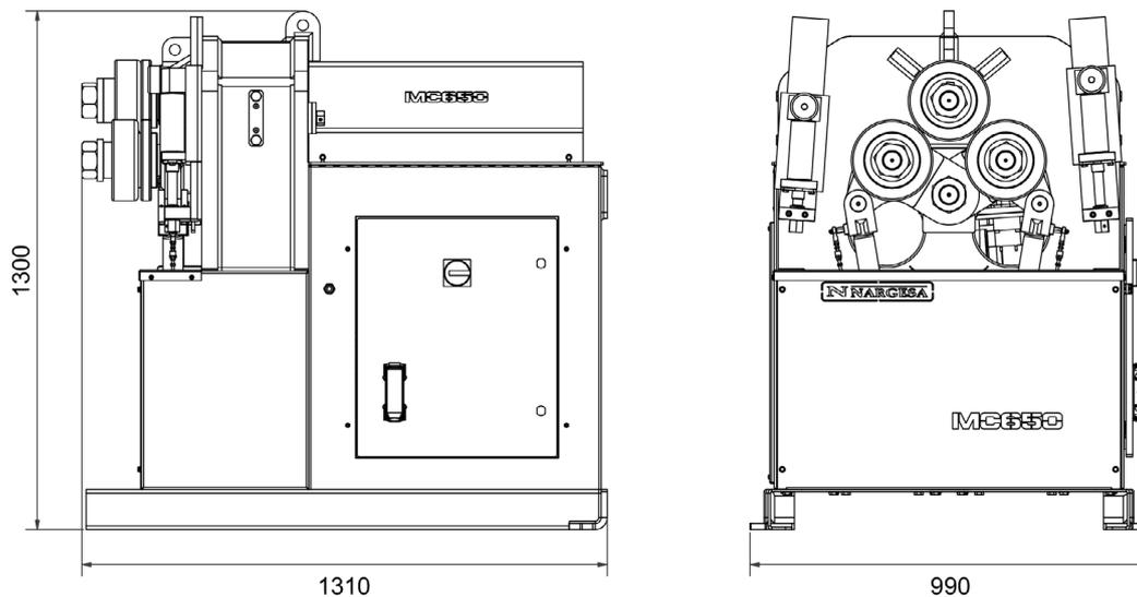
Figura 1. Dimensiones Exteriores de la Curvadora MC650
