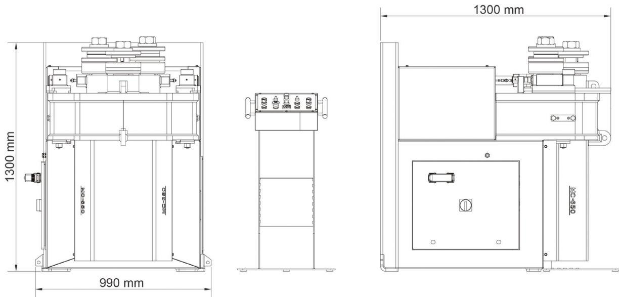
Figura 10. Dimensiones de la máquina con la bancada en posición horizontal
