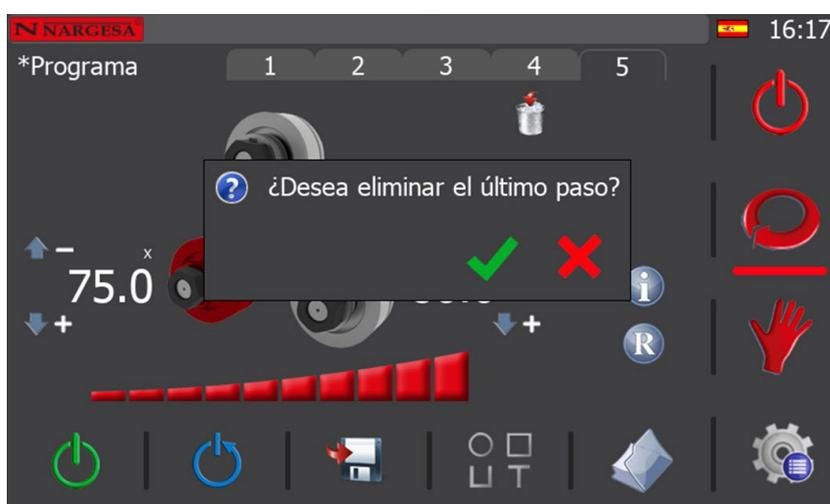
Como puede observar, en pantalla aparece un mensaje de confirmación para la eliminación del último paso guardado.
