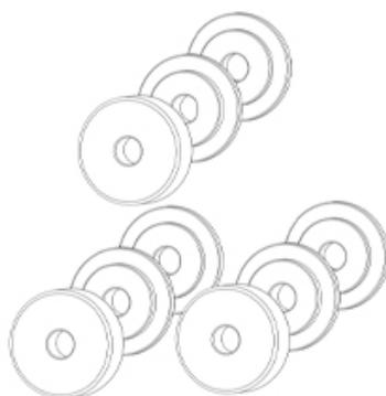
Figura 9. Posicionamiento de los rodillos respecto a los ejes de la máquina
