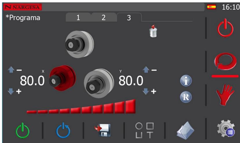
Ahora, con el material sujeto en la máquina, puede colocarlo en posición para empezar a curvar haciendo girar los rodillos hacia la derecha o hacia la izquierda, tal como aprendimos a hacerlo en el apartado del modo de trabajo manual.
