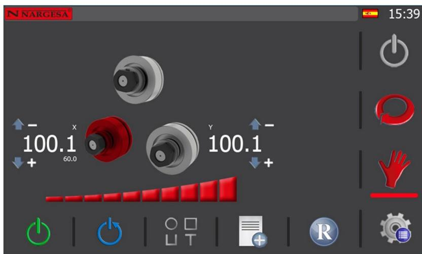
Ahora la máquina se encuentra en modo de posicionamiento del rodillo del eje X, a la espera de que se pulse al botón naranja de movimiento ubicado en el frontal del pupitre. Por tanto, si se mantiene presionado el citado pulsador, el rodillo del eje X comenzará a moverse desde su cota actual (100.1) hasta alcanzar la cota de destino fijada (60.0), momento en que el modo de posicionamiento concluye (en pantalla, desaparece la cota de destino).
