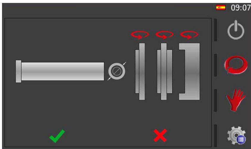
Mediante esta interfaz es posible voltear cada uno de los rodillos (presionado sobre la flecha situada sobre ellos) y colocarlos sobre el eje (presionando sobre el rodillo deseado). Tenga en cuenta que el orden en el cual presione cada uno de los rodillos será el orden en el que se irán insertando sobre el eje.
