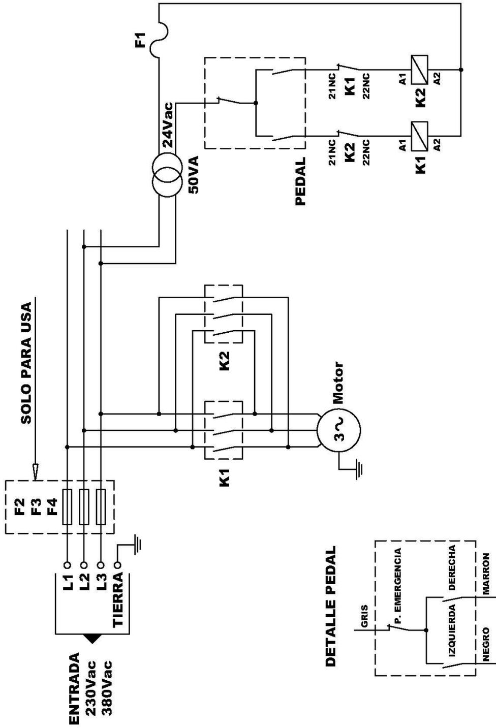
A3 Esquema eléctrico · MAQUINA MONOFASICA
