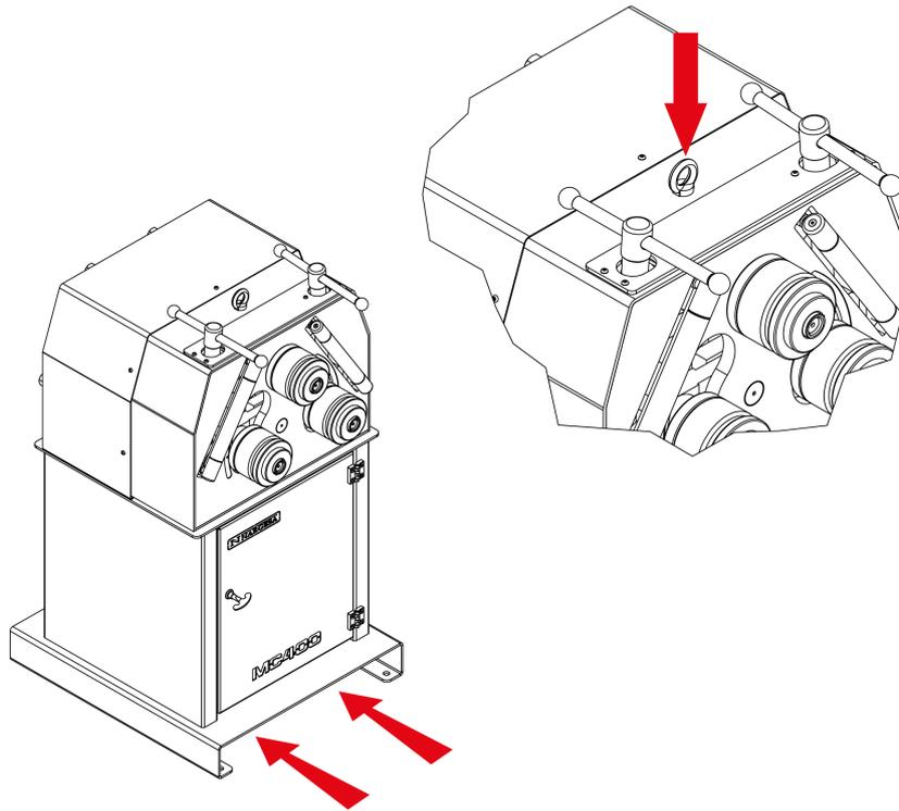
Figura 4. Transporte de la máquina
