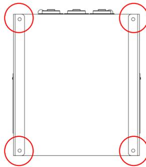
Figura 5. Puntos de anclaje de la máquina
