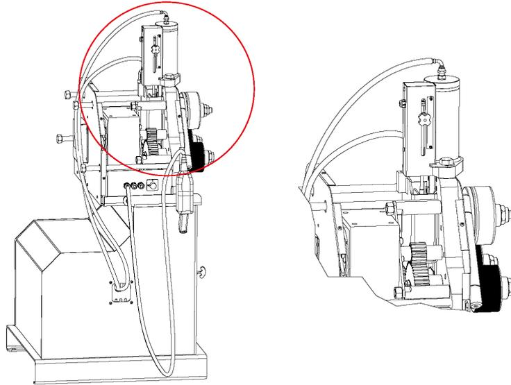
*Figura 3. Resguardos de protección de los mecanismos*
