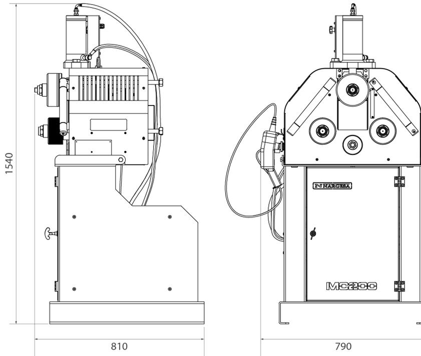
Figura 1. Dimensiones exteriores de la curvadora MC200H
