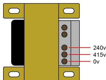
Figura 9. Cambio de las conexiones del transformador
