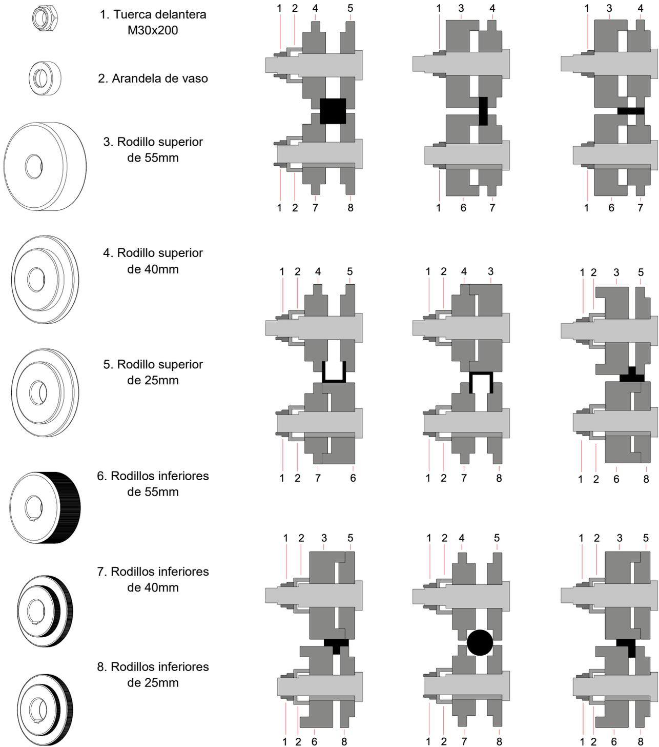
Figura 15. Nomenclatura de los rodillos y ensamblaje
