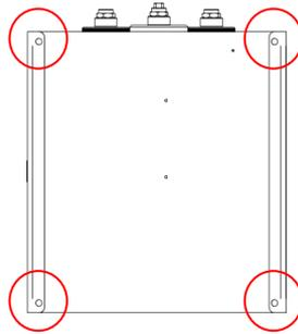
Figura 5. Puntos de anclaje de la máquina
