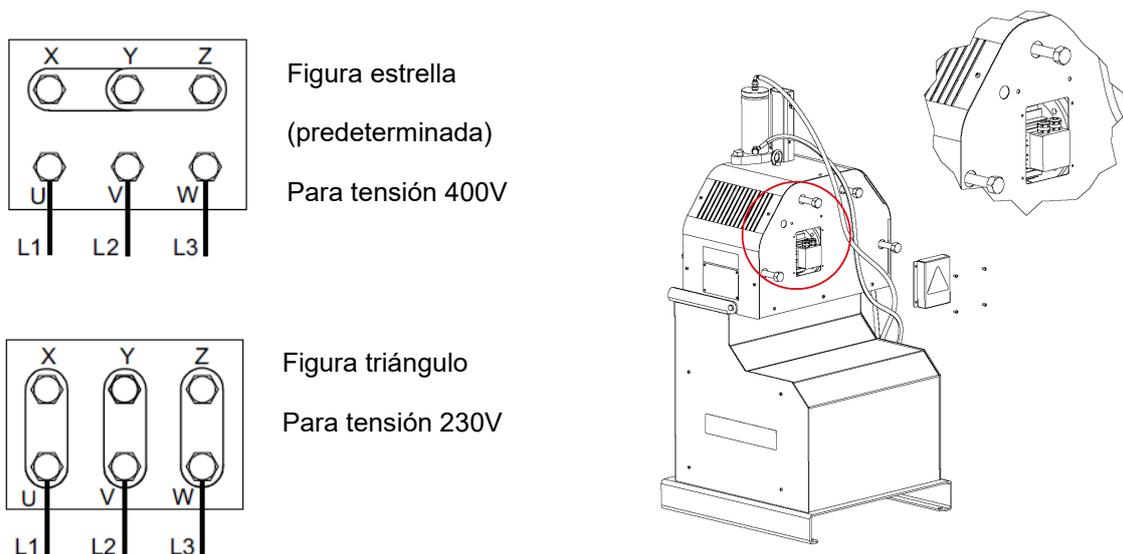
Figura 7. Cambio de las conexiones del motor
