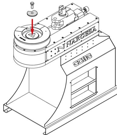
3. Colocamos la Contraforma o los Rodillos de apoyo en el Posicionador y la fijamos.
