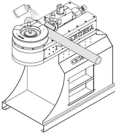
6. Deslizamos el Posicionador de la Contraforma hasta que esta se ajuste al material.
