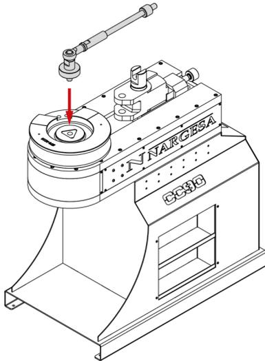
8. Colocamos el Brazo de reacción en la regata del Posicionador y ajustamos la tuerca con las manos hasta que este elemento quede sujeto y fijo.
