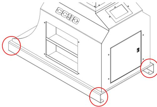
Figura 5. Puntos de anclaje de la máquina
