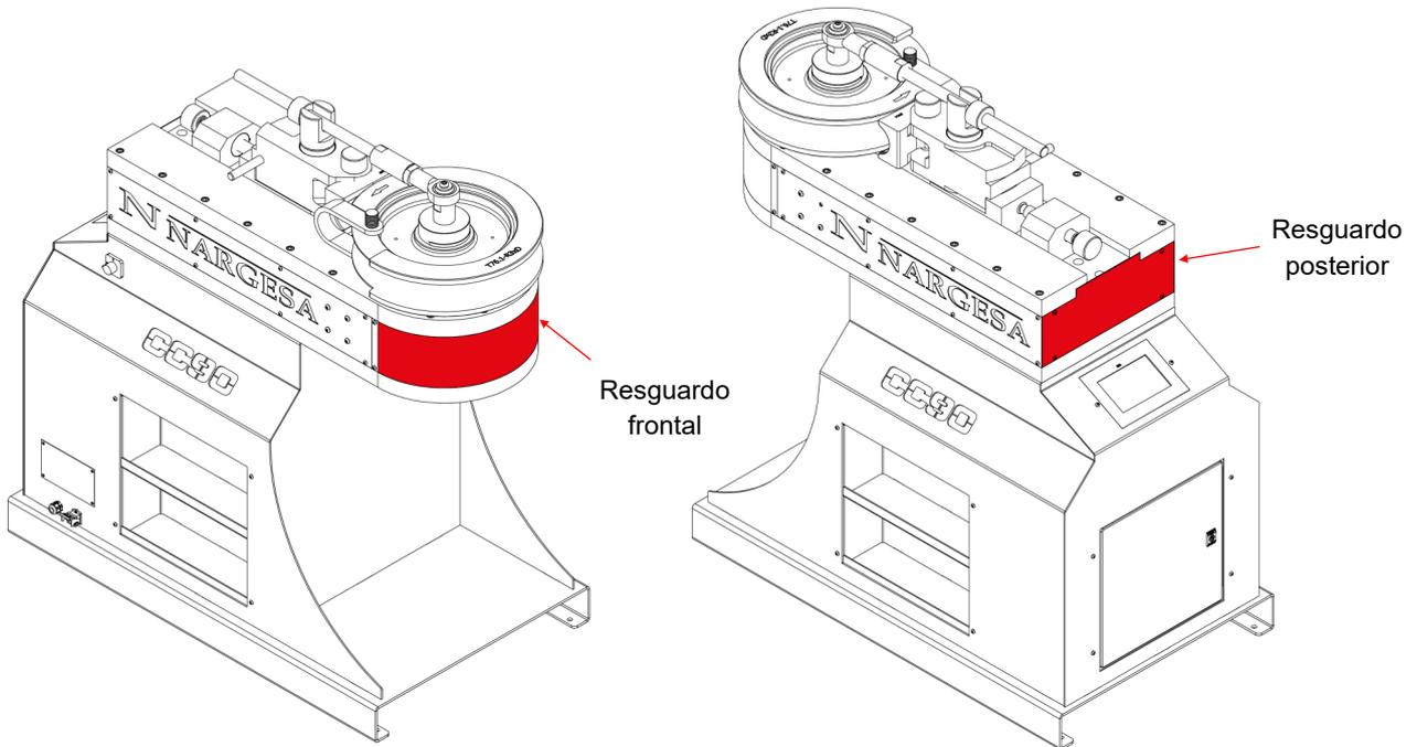
Figura 3. Resguardos de protección de los mecanismos
