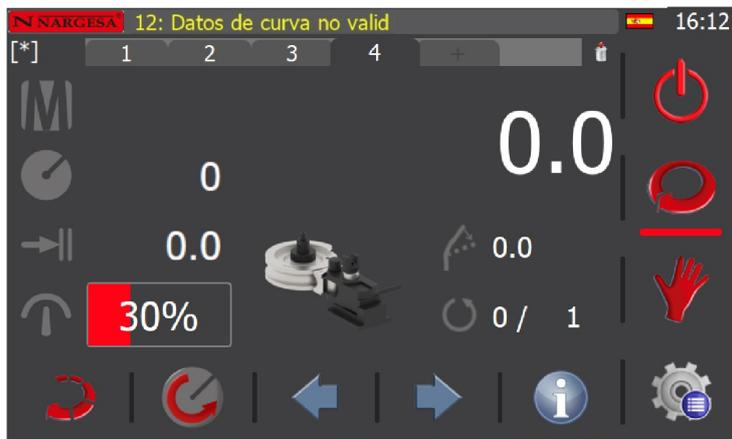
Rellenamos los parámetros de igual forma que en el Modo Manual: introducimos la sección del tubo, el radio de la Rulina, el espesor del tubo, el número de piezas que necesitamos y el ángulo de curvado.
