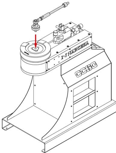
8. Colocamos el Brazo de reacción en la regata del Posicionador y ajustamos la tuerca con las manos hasta que este elemento quede sujeto y fijo.
