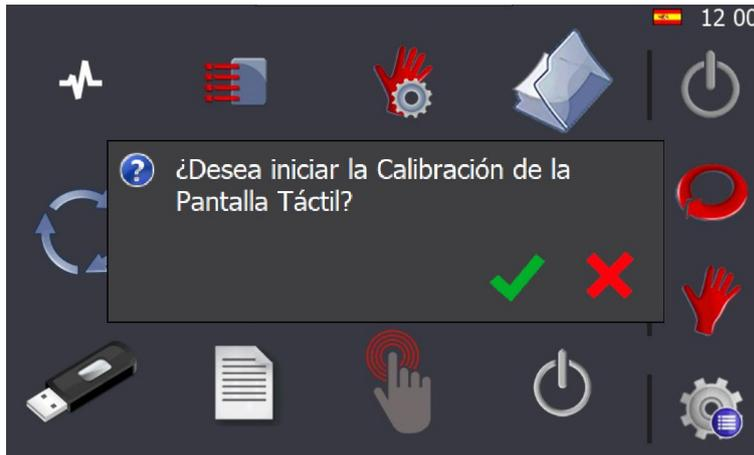
Si aceptamos, presionando sobre
