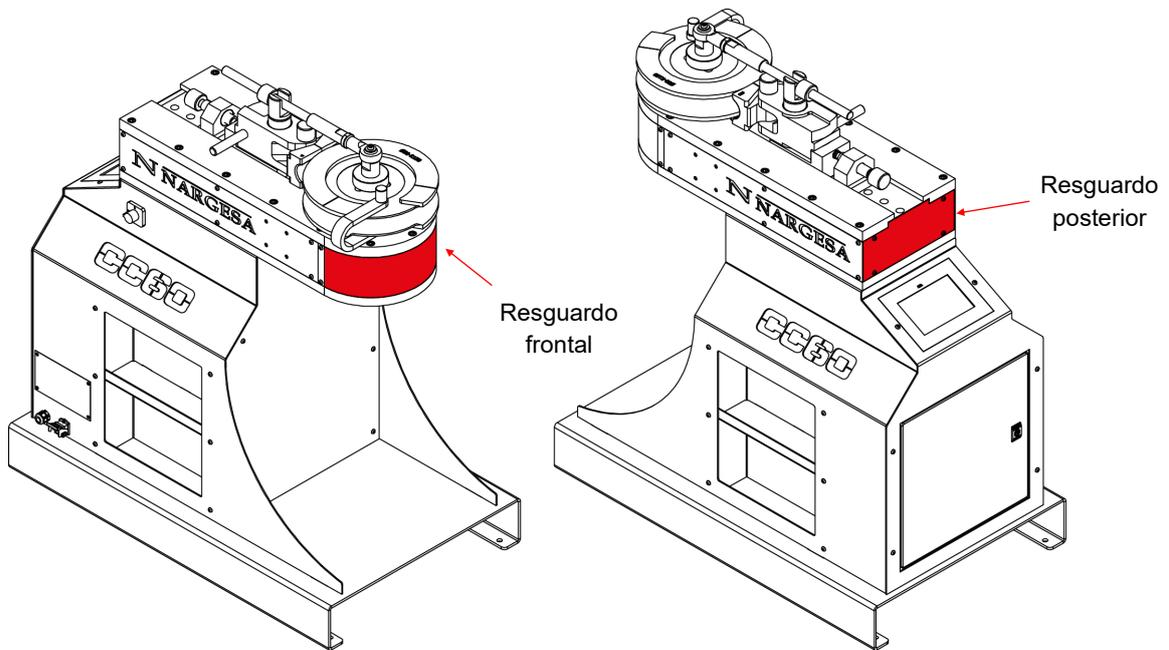
Figura 3. Resguardos de protección de los mecanismos
