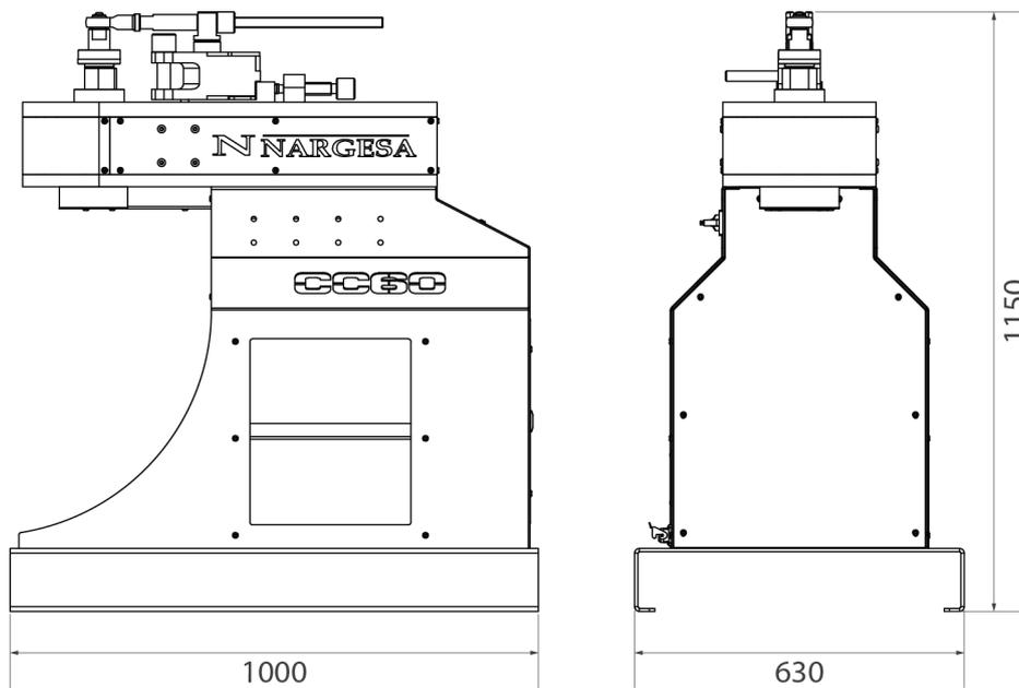
Figura 1. Dimensiones exteriores de la Curvadora CC60
