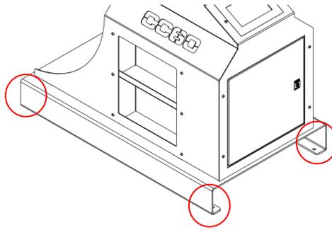
Figura 5. Puntos de anclaje de la máquina
