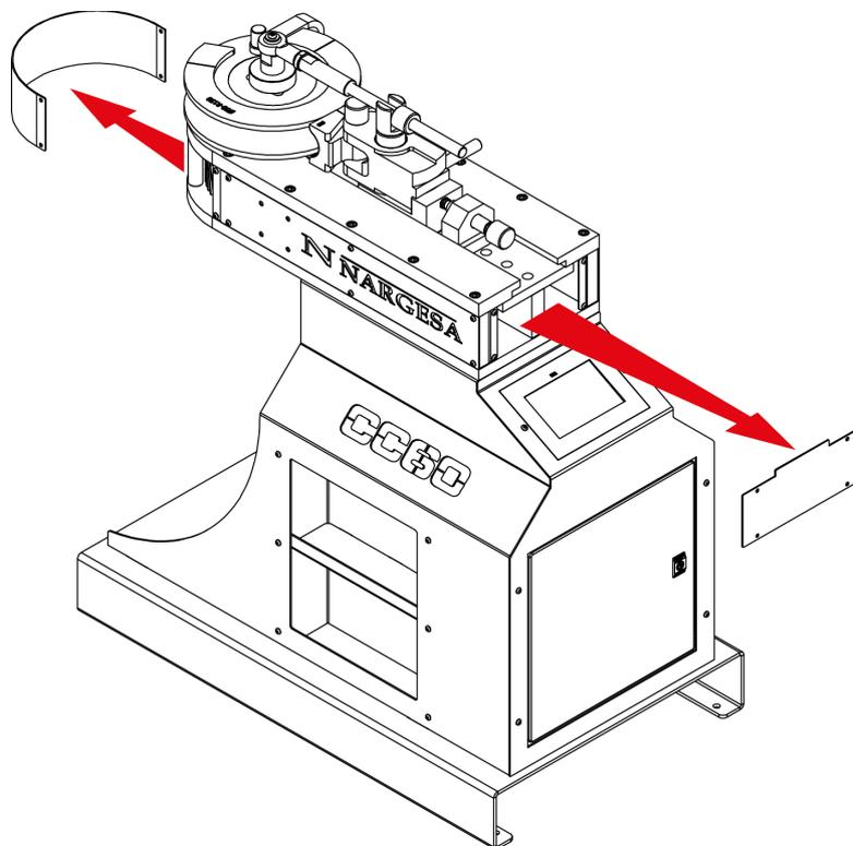
**ATENCIÓN:** Para proceder al engrase de la máquina es necesario parar la máquina y presionar el pulsador de "Paro de Emergencia".
