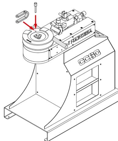
5. Lubricamos el tubo y la Contraforma con el spray BEND8
