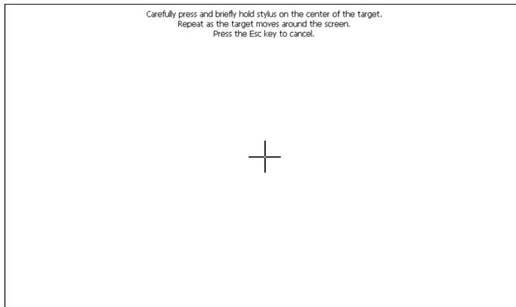
En el centro de la ventana aparece una cruz que hay que presionar unos instantes hasta que ella misma se ubica en una nueva posición. Este proceso se repite en distintos puntos de la pantalla hasta terminar la calibración táctil.
