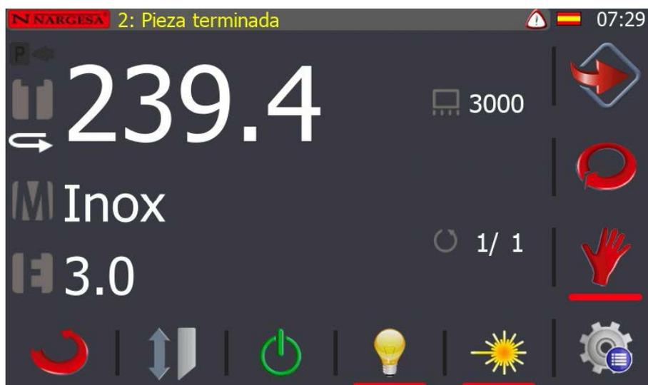
Mientras este icono se muestre en pantalla no podremos poner de nuevo en marcha la máquina. Por seguridad, este triángulo de advertencia nos indica que es necesario proceder a rearmar la cizalla. Para hacerlo, presionamos el botón azul de rearme y de forma automática desaparece el icono de advertencia de la barra de notificaciones.
