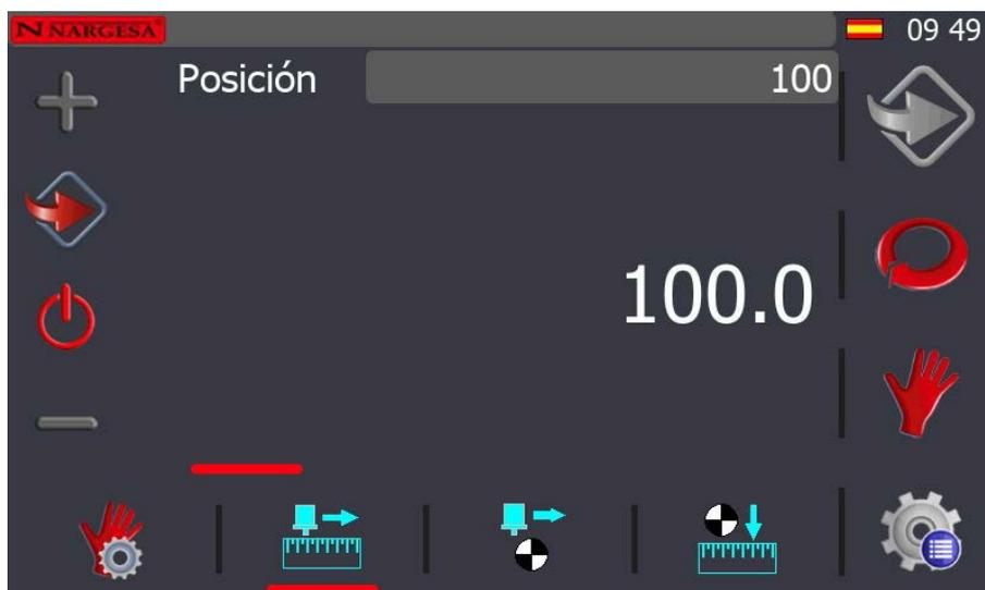
Ahora, con ayuda de un pie de rey o de un mira fondos comprobamos si la distancia existente entre el tope y la línea de corte marcada por el haz de luz laser corresponde a 100mm (o el valor de cota que hayamos introducido previamente).
