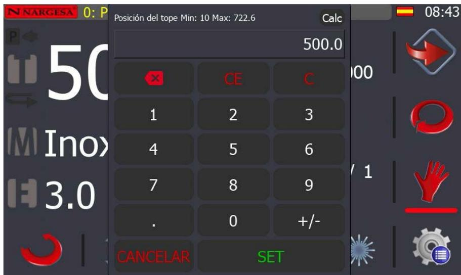
Con los dígitos introduciremos la cota requerida y pulsaremos la tecla **SET** con el mismo procedimiento introduciremos todos los datos del corte longitud , material y espesor y después pulsaremos la Tecla
