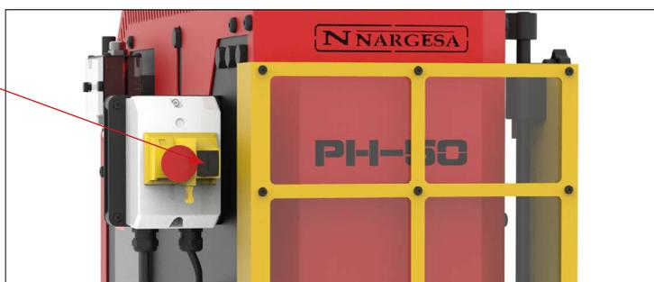
4. Colocamos la Palanca Principal en ON.
