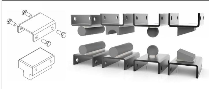
En caso que el cliente quiera fabricarse sus propias matrices, es importante que tanto la superior como la inferior, tengan una altura mínima de 75mm o 3" Pulgadas. Si activamos el pedal de accionamiento sin las matrices colocadas hay la posibilidad de causar daños en el vástago del PH50.
