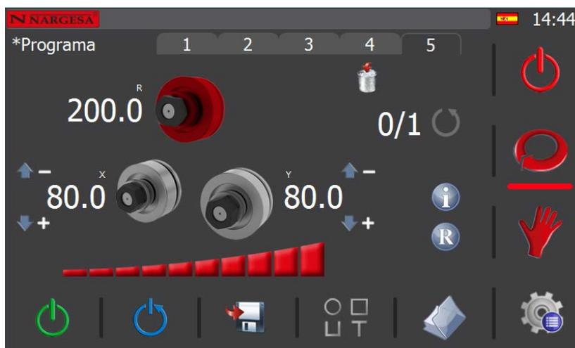
Ahora, con el material sujeto en la máquina, si selecciona el eje R, puede colocarlo en posición para empezar a curvar haciendo uso del joystick para girar los rodillos hacia la derecha o hacia la izquierda, tal como aprendimos a hacer en el apartado del modo de trabajo manual, o realizando un posicionado directo.
