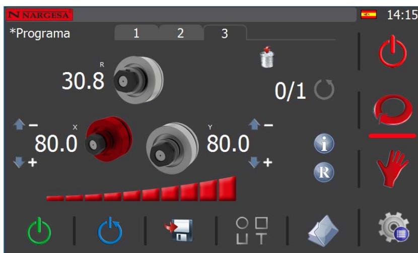
Al hacerlo, la aplicación crea un tercer paso para el programa. Este paso se denomina “paso de pinza” y es aquel en que el material que hay cargado en la máquina, listo para ser procesado, queda sujeto firmemente entre el rodillo superior y los dos rodillos inferiores.
