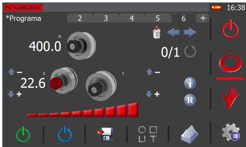
Como podemos apreciar, si seleccionamos el eje X interpolado, este y la tuerca de sujeción de los rodillos aparecen resaltados en color rojo. En este momento, si variamos la velocidad del eje haciendo uso de la barra de ajuste de velocidad ubicada debajo de los rodillos de los ejes X e Y, modificaremos únicamente la velocidad del eje interpolado seleccionado. En el ejemplo mostrado, hemos dejado la velocidad máxima para este eje en un 100% (velocidad por defecto para un eje interpolado).
