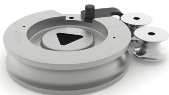
Rodillos fabricados en Acero y tratados. Conjuntos aptos para curvar tubo de 2" Schedule y espesor igual o superior 2,77mm
