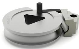
Rodillos fabricados en Acero y tratados. Conjuntos aptos para curvar todo tipo de tubos redondos de 12 a 60 milímetros.
