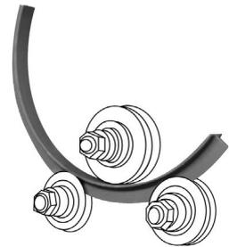
Galets ajustables à la mesure du tube ou profilé, ce qui nous permet de réaliser des courbes de différentes dimensions de tube ou de profilé.
