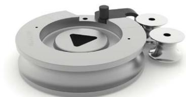
Rouleaux fabriqués en acier et traités. Assemblages adaptés pour courber un tube de 90mm et une épaisseur égale ou supérieure à 4mm. Le jeu contient: Une forme, une bride avec goupille, deux rouleaux porteurs.
