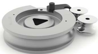
Rouleaux fabriqués en acier et traités. Jeux conçus pour cintrer tous les types de tubes ronds de 3" 1/2 et une épaisseur égale ou supérieure à 4mm. Le jeu contient: Une forme, une bride avec goupille, deux rouleaux porteurs.
