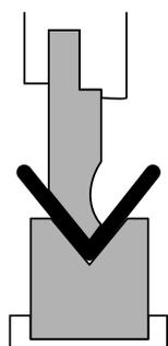
**2. Plegado a fondo:** Es el realizado sobre la matriz, presionando la chapa con el punzón hasta que se alcanza la parte inferior de la misma. El ángulo de plegado resultante depende de las herramientas utilizadas.
