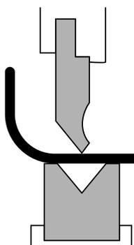
**4. Calandrado:** Es el que permite obtener diferentes radios de curvatura de una chapa a partir de múltiples plegados secuenciales realizados sobre la misma.
