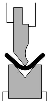
**1. Plegado al aire:** Es el realizado sobre la matriz sin que la chapa plegada con el punzón alcance la parte inferior de la misma. Esto permite obtener diferentes ángulos de plegado utilizando las mismas herramientas, lo que requiere trabajar con extrema precisión para garantizar un resultado perfecto.
