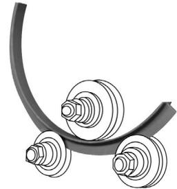
Rodillos ajustables a la medida del tubo o perfil, lo cual nos permite realizar curvados en diferentes dimensiones de tubo o perfil.
