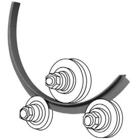
Rodillos ajustables mediante arandelas a la medida del tubo o perfil, lo cual nos permite realizar curvados en diferentes dimensiones de tubo o perfil.
