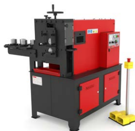
MAQUINAS DE GRAVAR EN FRÍO
