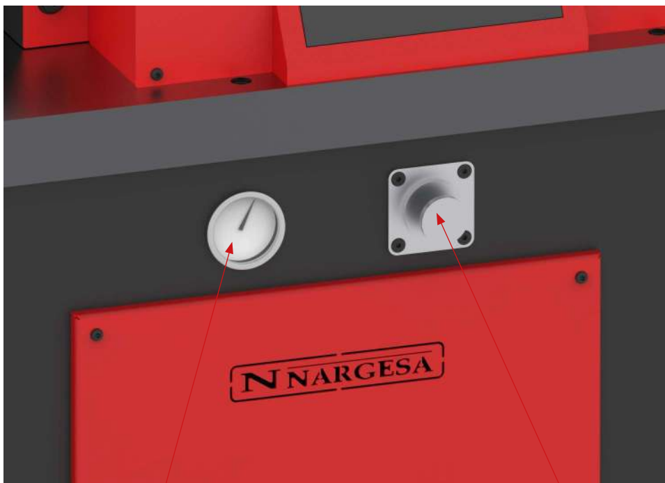
Illustration 9. Éléments du réglage de la force.
