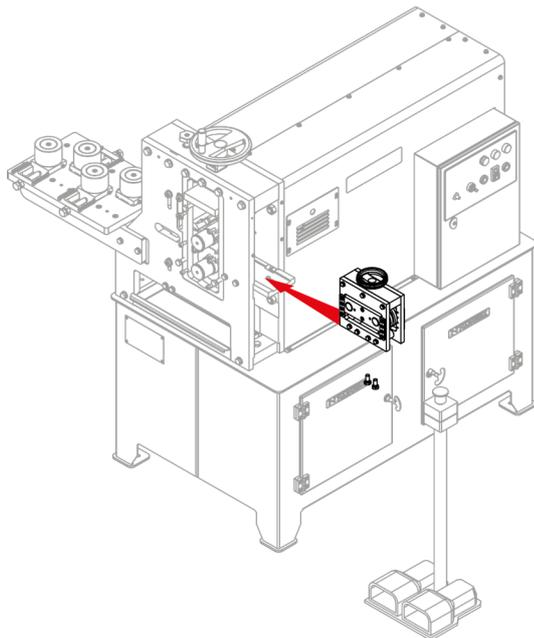
2. Atornillar los dos tornillos de fijación al utillaje por la parte inferior de la guía de entrada de la máquina
