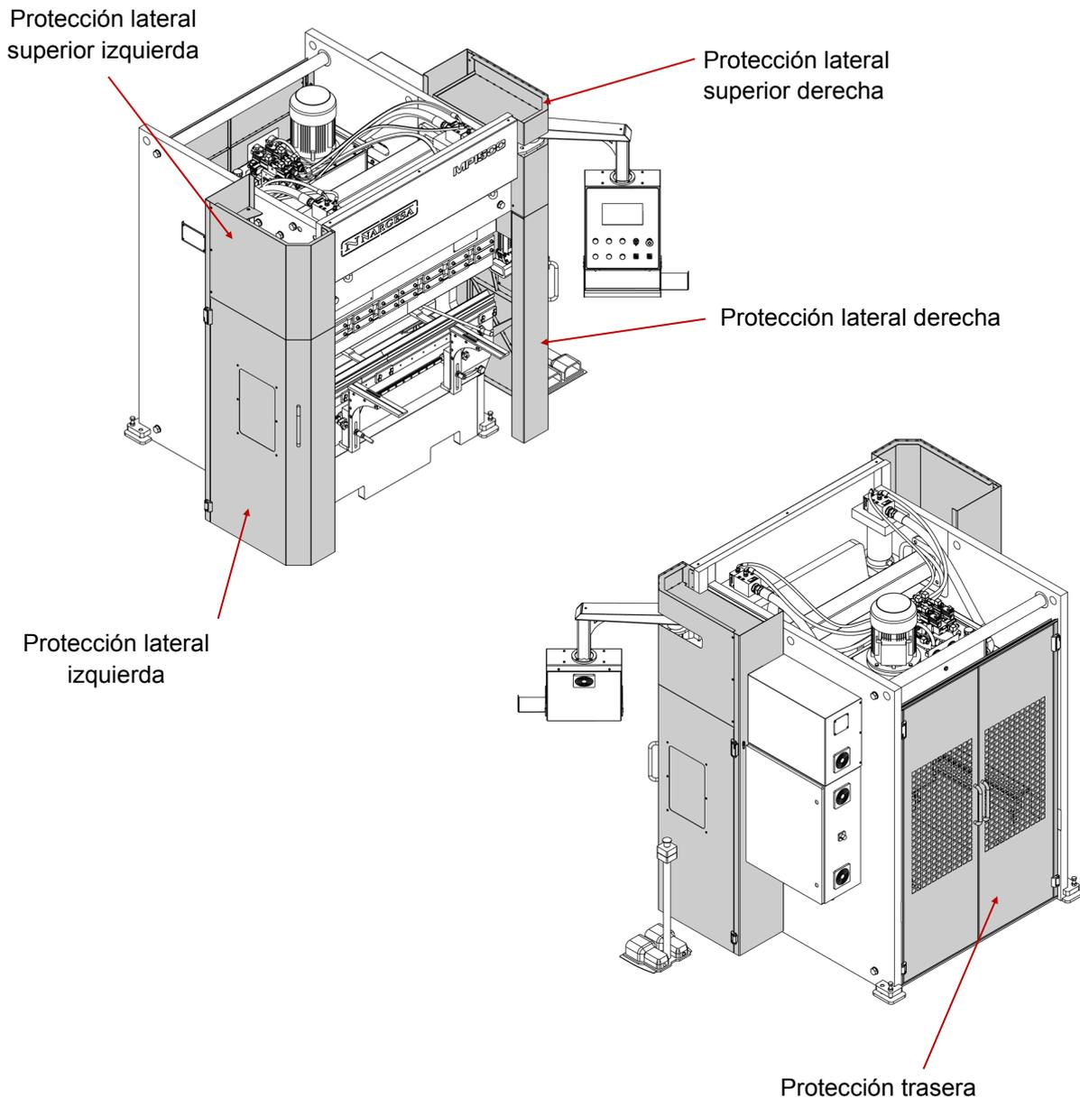
No se pueden quitar las tapas de protección si no es para realizar tareas de mantenimiento y deben ser realizadas por personal técnicamente formado. PRADA NARGESA no se responsabiliza de los daños causados por no atenerse a lo anteriormente mencionado.
