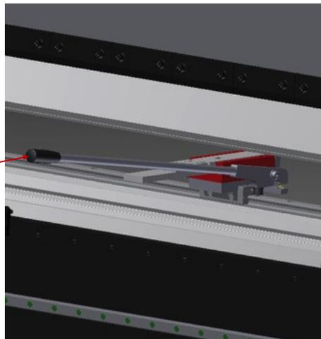
Para proceder al movimiento de las agujas introduciremos la barra de accionamiento en el alojamiento existente en el soporte de la aguja.
