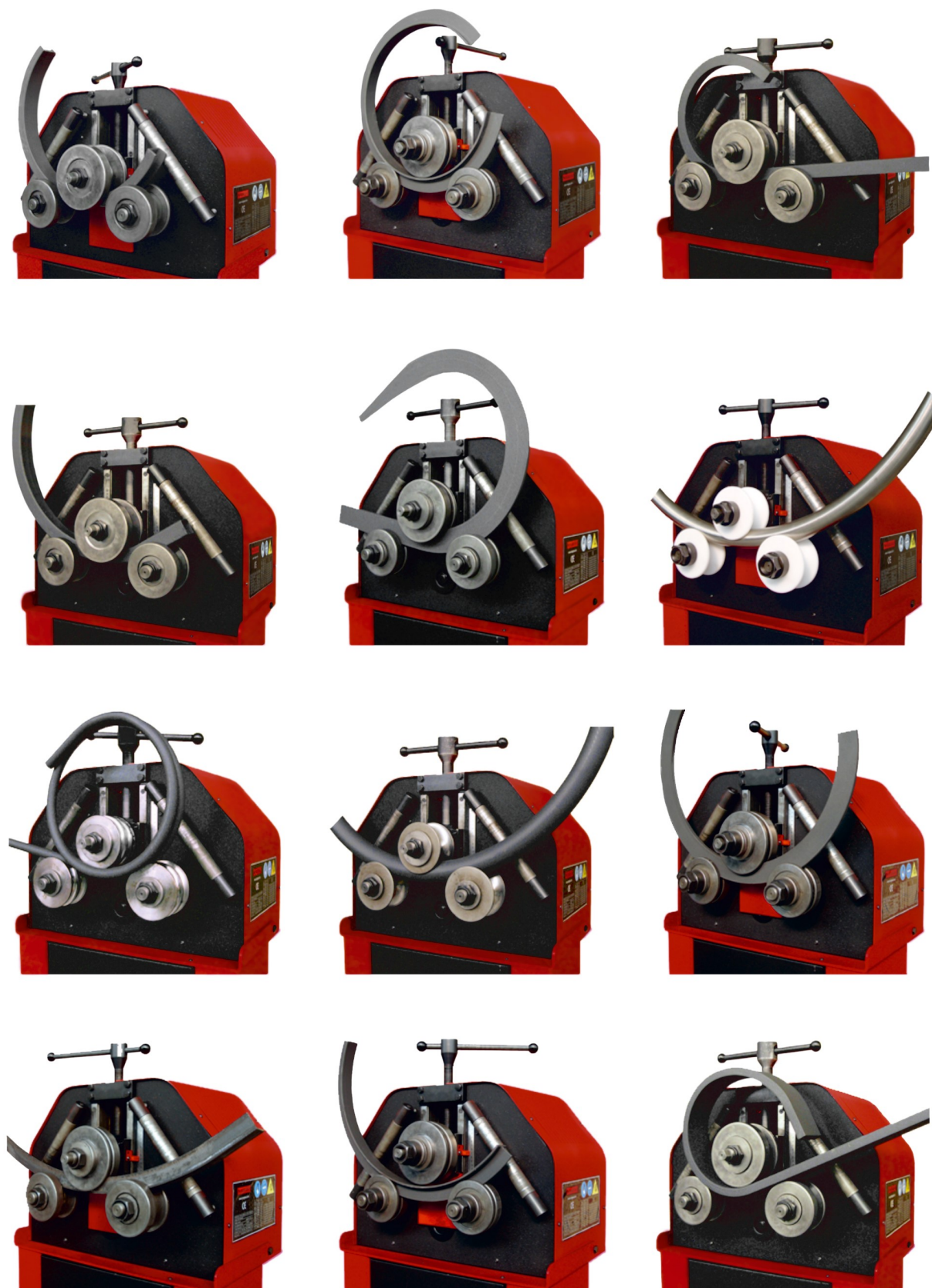
Figura 14. Ejemplos de curvado en diferentes tubos y perfiles
