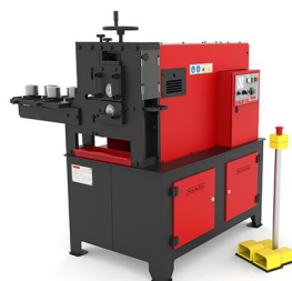
MAQUINAS DE GRAVAR EN FRIO
