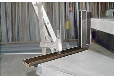
4. Uma ferramenta especial é ancorada no lado externo da etapa. Isso faz parar na frente e na lateral do degrau e nos diz onde colocar o próximo.
