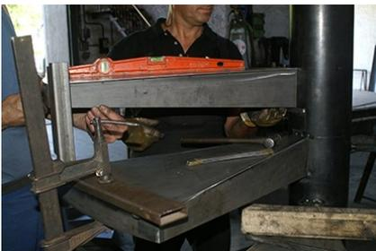
7. Nivelamos o degrau de modo que fique completamente paralelo ao solo.
