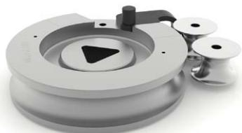
Rodillos fabricados en Acero y tratados. Conjuntos aptos para curvar tubo de 90 milímetros y espesor igual o superior 4mm.
