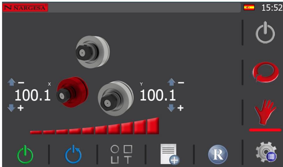
Ahora es cuando puede comenzar a crear la barra de muestra. Para hacerlo, posicione cada uno de los rodillos en una cota tal que pueda cargar en la máquina, sin problemas, el perfil con el que va a trabajar.
