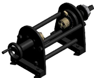
Outillage pour réaliser des pommes de pin de toutes sortes, de différentes mesures, sur barres carrées ou rondes.
