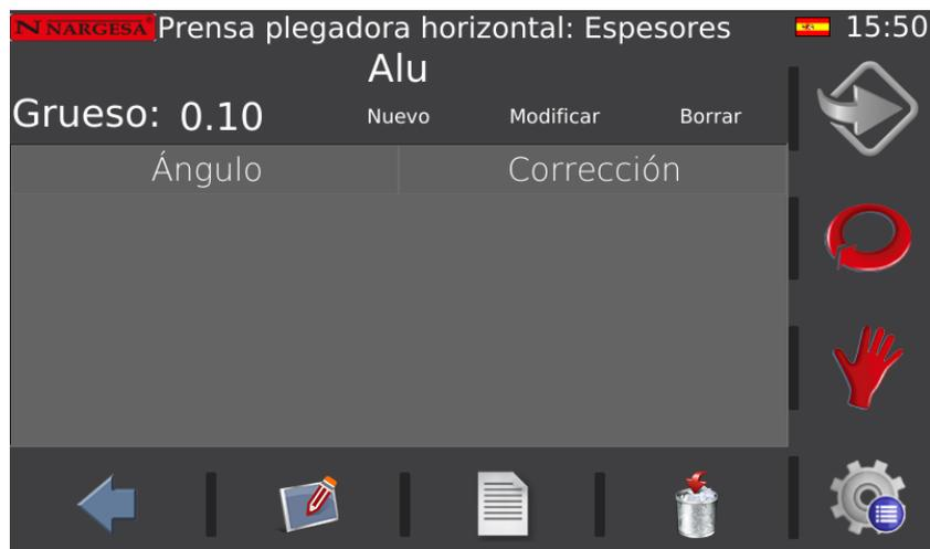
Una vez dentro de esta ventana es posible crear, modificar o borrar espesores mediante la presión sobre el texto situado en la línea horizontal a la altura del espesor.
