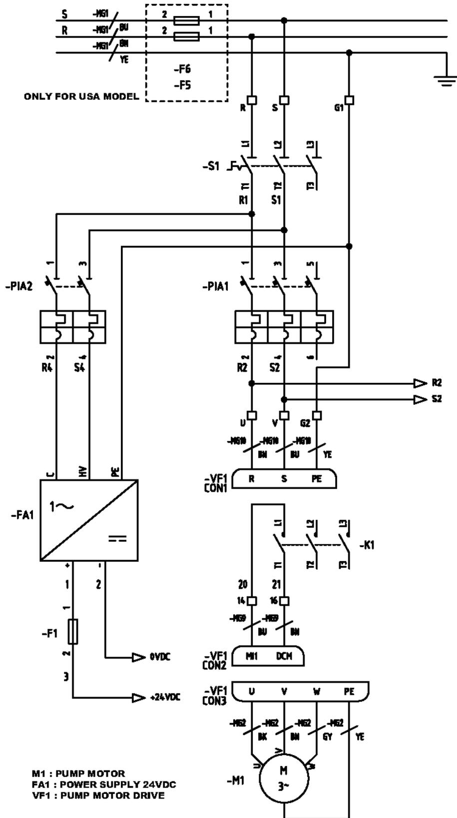
A10. Esquema eléctrico · MAQUINA MONOFASICA
