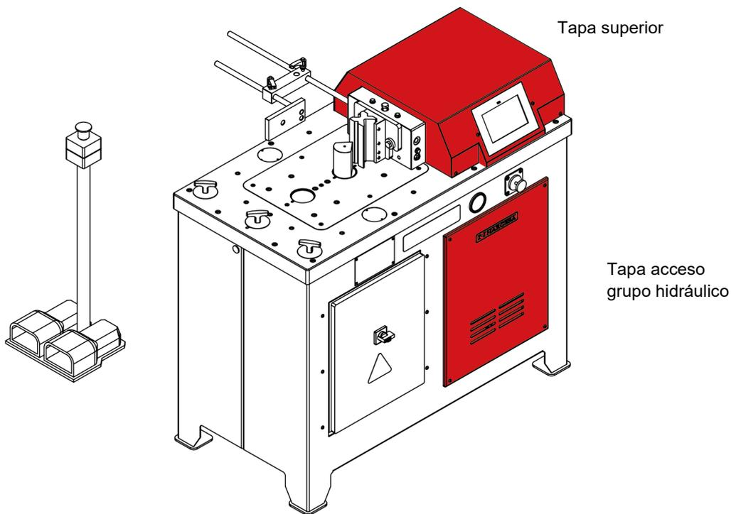
Figura 4. Localización de las protecciones de seguridad
