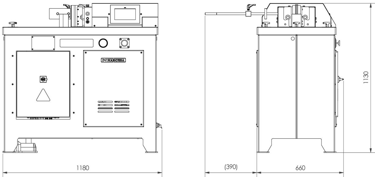
*Figura 1. Dimensiones exteriores de la Prensa plegadora horizontal*
