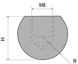
Elementos de radio para plegar. Fabricadas en C45, un acero de grado medio, de alta calidad, con propiedades mecánicas constantes y con buena resistencia cromada exteriormente.
