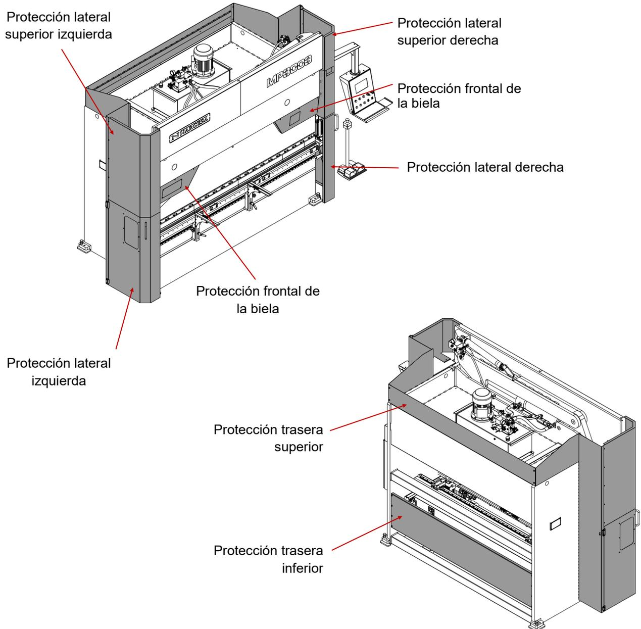
No se pueden sacar las tapas de protección si no es para realizar tareas de mantenimiento y deben ser realizadas por personal técnicamente formado. PRADA NARGESA no se responsabiliza de los daños causados por no atenerse a lo anteriormente mencionado.
