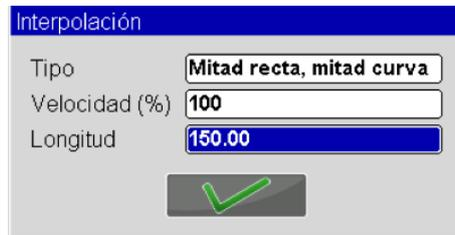
Los datos que definen cualquier interpolación en la máquina curvadora Nargesa MC650 CNC son tres: tipo de interpolación, velocidad de interpolación y longitud de interpolación.
