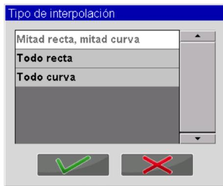
Aquí es donde se puede seleccionar el tipo de interpolación que la máquina utiliza para crear los distintos radios de la geometría.
