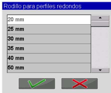
Es importante comentar que al escoger un perfil redondo, su diámetro y el de los rodillos utilizados para dar forma geométrica a la pieza, debe concordar exactamente. De ahí que aparezca un listado como el anterior cuando se edita el diámetro del perfil. Solo así es posible garantizar que va a utilizarse el rodillo adecuado para el diámetro deseado.
