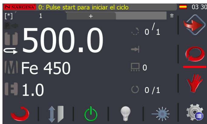
En esencia, el modo automático es como un modo manual donde pueden especificarse diferentes pasos de trabajo con distintas cotas de corte, que se guardan dentro de un programa.
