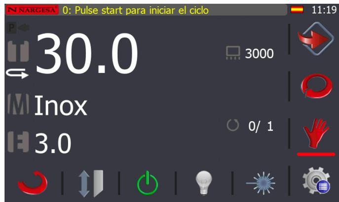
Es este momento el control permite realizar cortes de forma manual , tan solo necesitamos introducir los datos del corte , para introducir la medida de corte pulsaremos en la medida de corte y aparecerá esta pantalla
