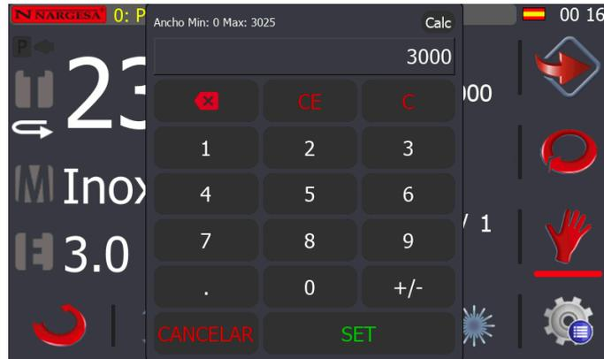
Ahora podemos introducir un nuevo valor de anchura para la chapa lateral, entre un mínimo de 0 y la cota máxima lateral especificada como parámetro de fábrica.
