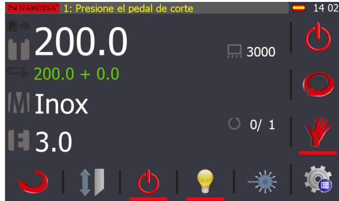
Dentro de este modo de funcionamiento también podremos escoger el sistema de trabajo, continuo o simple , tal y como se puede ver en la anterior imagen el control por defecto selecciona el modo Manual. Podemos escoger el cambio de modo tan solo con pulsar esta tecla
