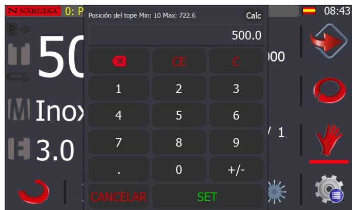
Con los dígitos introduciremos la cota requerida y pulsaremos la tecla **SET** con el mismo procedimiento introduciremos todos los datos del corte longitud , material y espesor y después pulsaremos la Tecla
