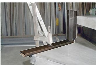
4. Se ancla un utillaje especial en la parte exterior del escalón. Este hace to-pe en la parte delantera y lateral del escalón y nos indica donde poner el siguiente.
