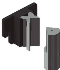
> Matrice de pliage jusqu'à 161mm avec 4 ouvertures (16, 22, 35, 50mm) et un poinçon de 80°. Cette forme permet de plier des tôles de 1mm à 8mm. Le poinçon de diamètre extérieur de 70mm permet de réaliser des formes complètement fermées jusqu'à un minimum de 75mm d'aile intérieure.
